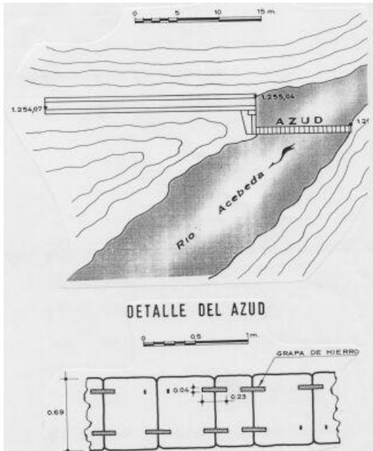
de traza romana, formado por 26 piezas de granito, de 69 cm de anchura y longitudes variables, grapadas con llantones de hierro y recibidos con plomo. Está inclinado unos 45 grados con respecto al eje del río para derivar sus aguas por la margen derecha hacia un canal descubierto que vierte las agua a un decantador de arenas (abierto también, por lo que se puede apreciar su funcionamiento) que a su vez introduce el agua por la tubería enterrada.
