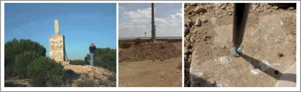
Figura 4. Izquierda: Vértice Geodésico de Trigo (VG1). Centro y derecha: Antigua baliza del río Guadalquivir, en cuya base se encuentra el clavo de bronce J. P. S.-N. T. 106 (VG3).
