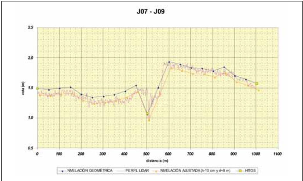
Figura 9. Perfil de la sección transversal N- J07-J08-J09 levantada en el caño Travieso con la Ampliación de la Red de Nivelación Geométrica de la marisma del PND (2005-06). En azul la nivelación geométrica con precisión (9-09-2005). En rosa el mismo perfil determinado con el del vuelo Lidar (2002). La diferencia entre la línea naranja y la azul es el desplazamiento que requiere la sección Lidar para encajar con el levantamiento ortométrico.
