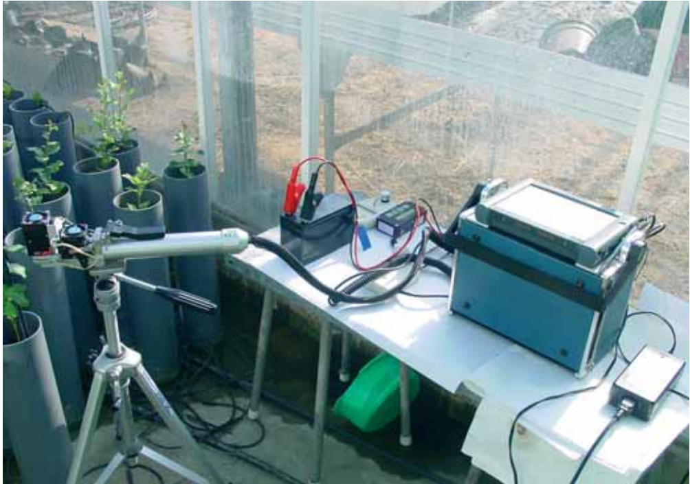
Foto 7.3. Instalación para medir la fotosíntesis con un analizador de intercambio gaseoso IRGA modelo Ciras-2, PP-System. Autor J. L. Quero.
