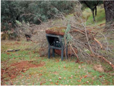
Detalle de la c mara protegida por una carcasa de madera y camuflada con ramaje.
