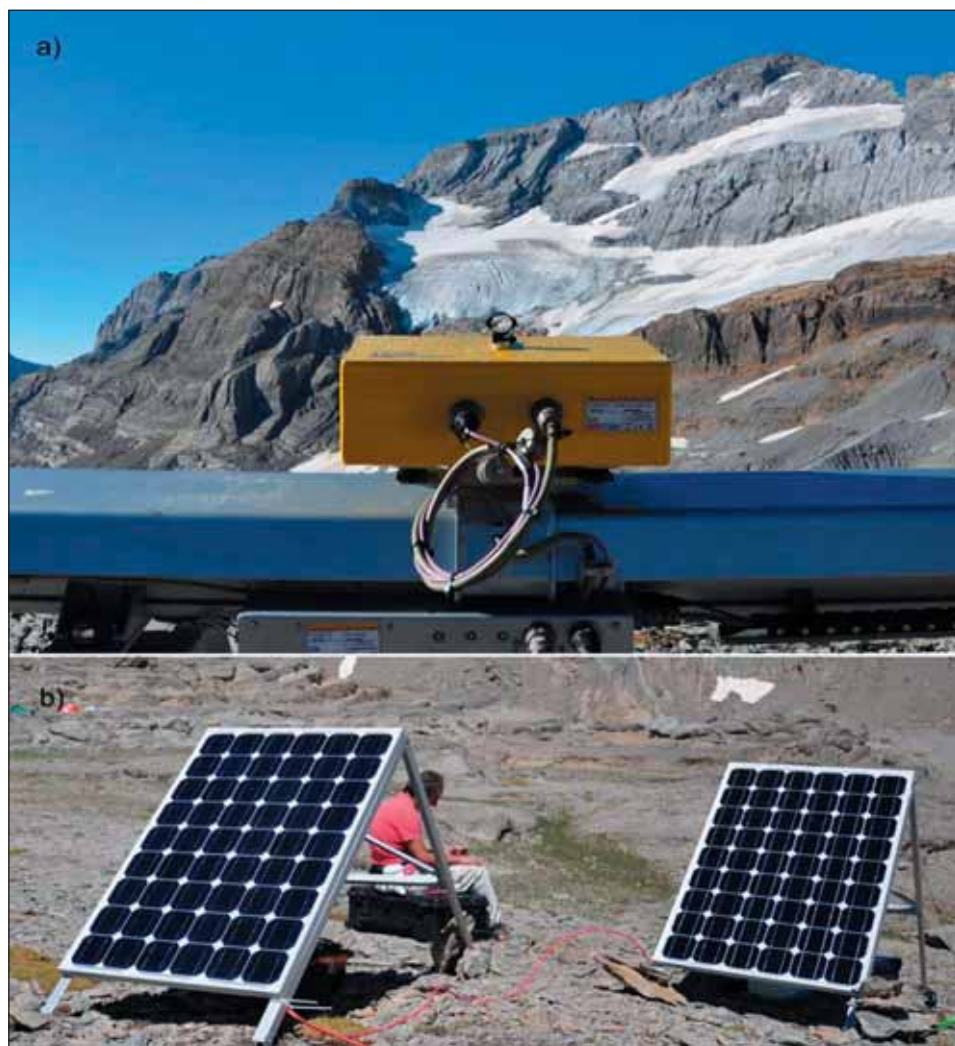
Figura 3. Sensor GB-SAR desde el punto de medición.
