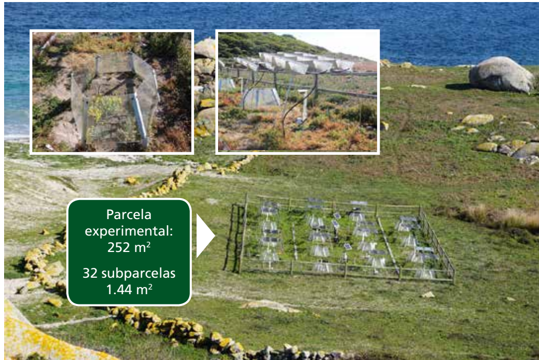
Figura 1. Vista general de la parcela de experimentación en la Isla de Sálvora. Se observa en detalle una de las ocho cámaras de metacrilato y los colectores de precipitación, sobre el mástil, una de las cámaras "time-lapse" y los sensores atmosféricos.
