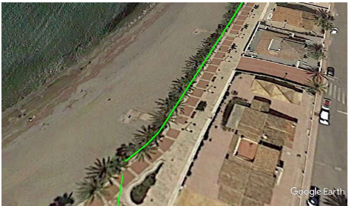
Figura 24. Recorrido de la poligonal de deslinde. Vista área en el tramo comprendido entre el DP-09 a DP-12. Trazado por el borde exterior del paseo marítimo
