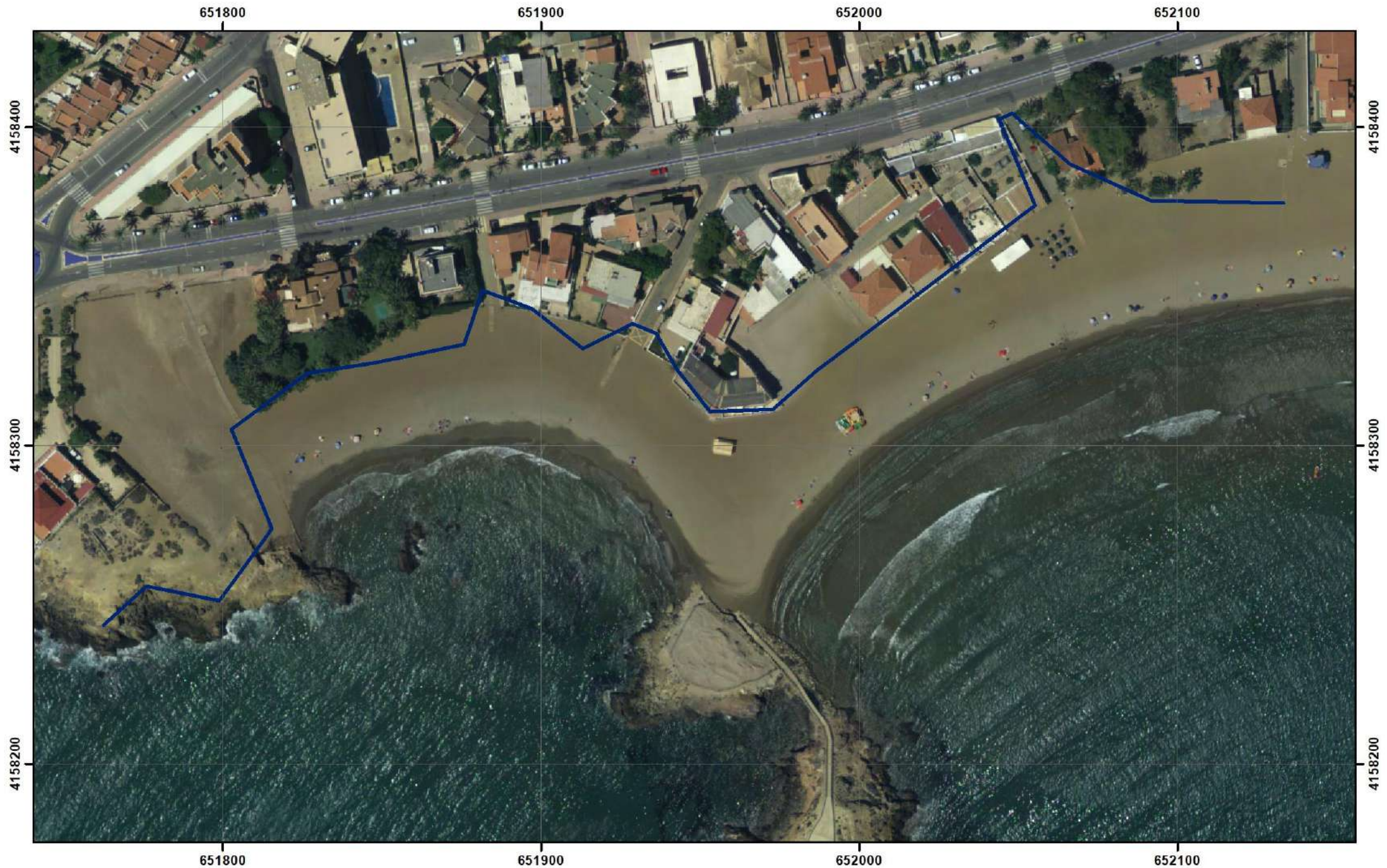
Línea de inundaciones para la cota 1,30 sobre el N.M.M.A., sobre ortofotografía, en el sector de playas con orientaciones batimétricas del perfil 2. Plano a escala 1:600,965 en el sistema-datum ETRS89.
