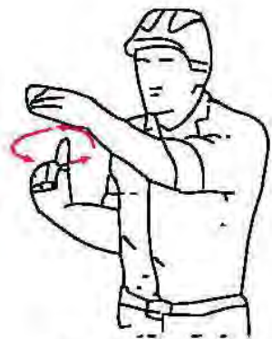
5 Levantar el aguilón o pluma y bajar la carga
