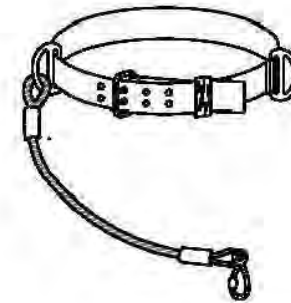
CINTURON DE SUJECION CAMPO DE APLICACION: PARA IMPEDIR LA CAIDA LIBRE CON EL ELEMENTO DE AMARRE SIEMPRE TENSO TRABAJOS EN CUBIERTAS, CANTERAS, ANDAMIOS, ESCALERAS, POSTES, ETC.
