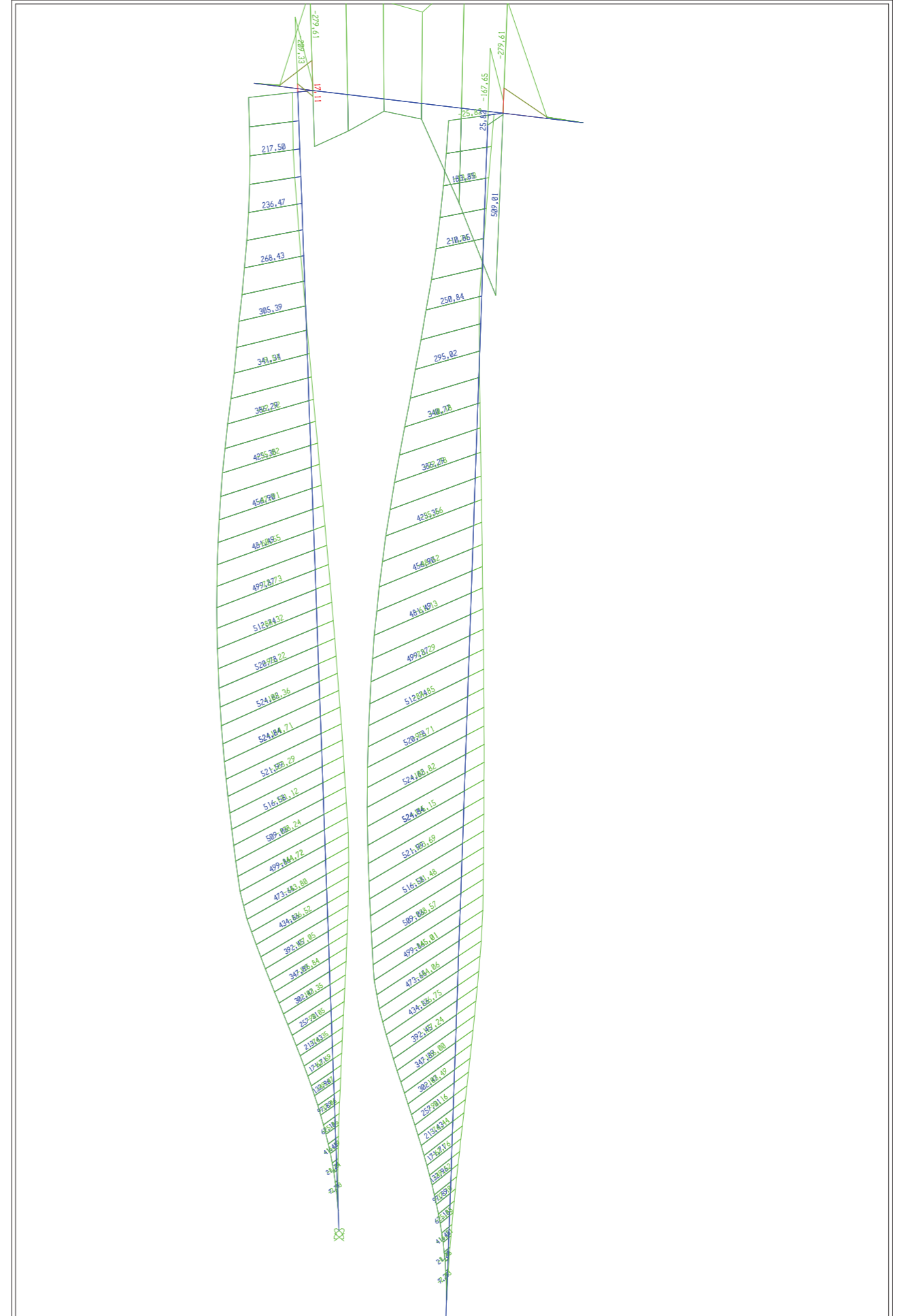
SAP2000 v15.1.0 - File:MODELO ESTRIBOS CARGADERO - Moment 3-3 Diagram (ENVD) - KN, m, C Units
