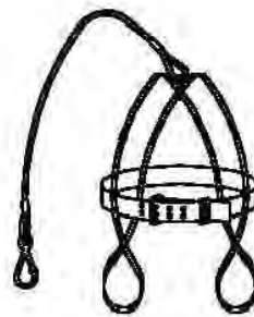
CINTURON DE CAIDA CAMPO DE APLICACION: TRABAJOS CON POSIBILIDAD DE CAIDA LIBRE
