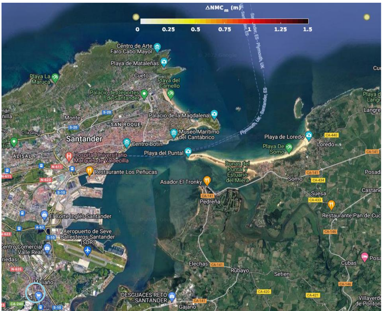
Ilustración 30. Incremento del nivel del mar en el período 2026-2045 para el escenario RCP8.5 (Fuente: Instituto de Hidráulica Ambiental, Cantabria. Año 2022)
