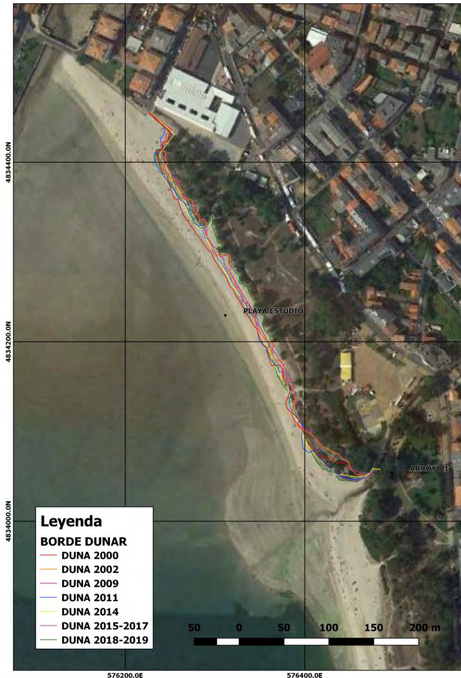
Imagen 58. Colección de líneas de costa obtenidas a partir de la digitalización de las imágenes satelitales de Google Earth para la zona norte de la playa de A Magdalena, entre el río Condomiñas y el arroyo Rego da Veiga. Fuente: Google Earth y elaboración propia.
