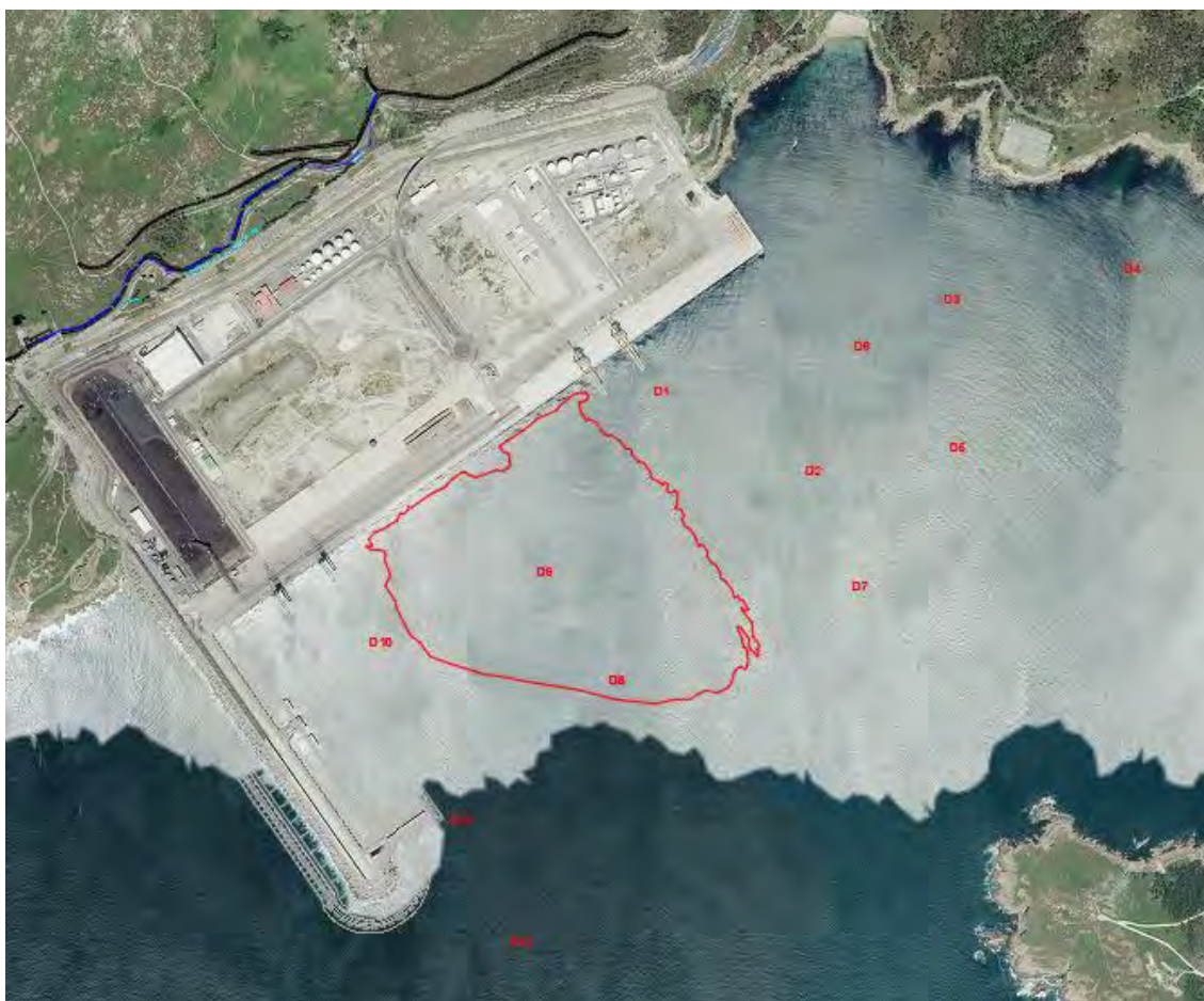
Imagen 12. Plano de situación del muestreo sedimentológico de la dársena del Puerto exterior de Ferrol VS superficie a dragar. Fuente: Control bionómico y sedimentológico durante la ejecución del proyecto de ampliación del puerto de Ferrol del año 2009 (en adelante Control bionómico y sedimentológico 2009) 1
