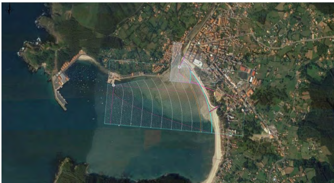
Imagen 42: Forma en planta de equilibrio definida para la alternativa seleccionada. Fuente: Elaboración propia.
