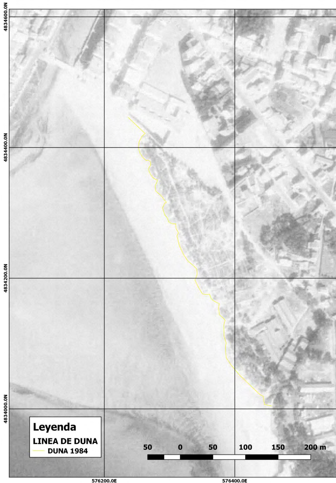
Imagen 11: Línea de borde dunar obtenida a partir de restitución del vuelo vertical Nacional 1980-86 para la zona norte de la playa de A Magdalena, entre el río Condomiñas y el arroyo Rego da Veiga. Fuente: IGN y elaboración propia.
