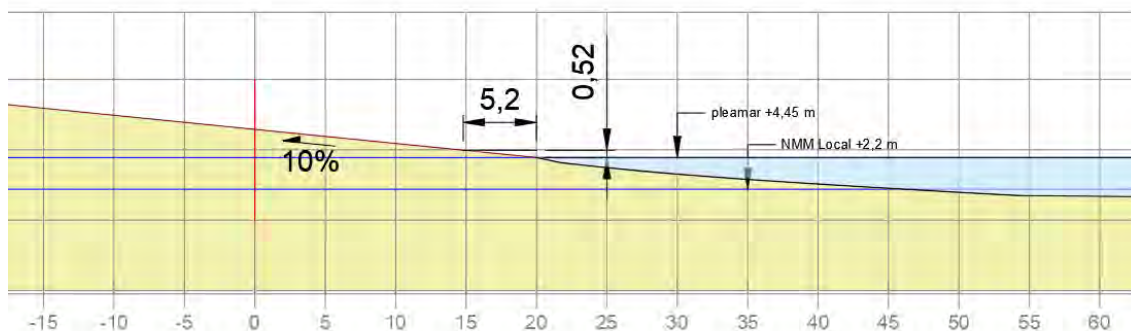
Imagen 115: Retroceso de la playa seca (2100) por el incremento del nivel medio del mar en la zona de estudio debido al Cambio Climático. Fuente: Elaboración propia.
