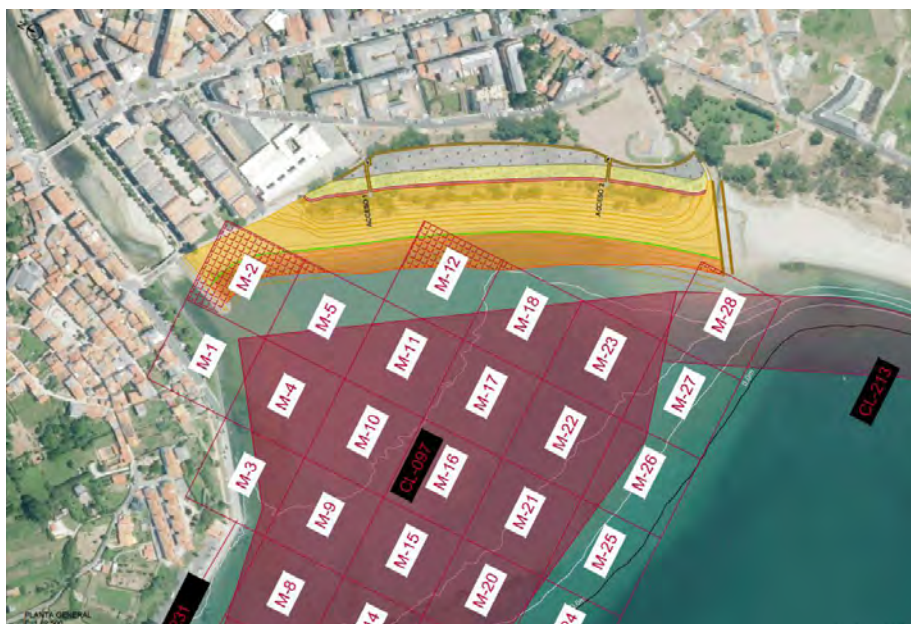
Imagen 124. Planta de actuaciones, bancos marisqueros (sombreado sólido granate), cuadrícula de muestreos (cuadrados codificados como M-0) y zona de afección considerada (sombreado reticular en granate). Fuente: elaboración propia.
