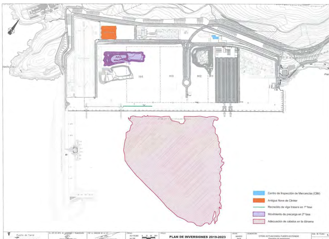
Imagen 11. Dragado previsto en la dársena del Puerto Exterior de Ferrol. Fuente: AP de Ferrol – San Cibrao.
