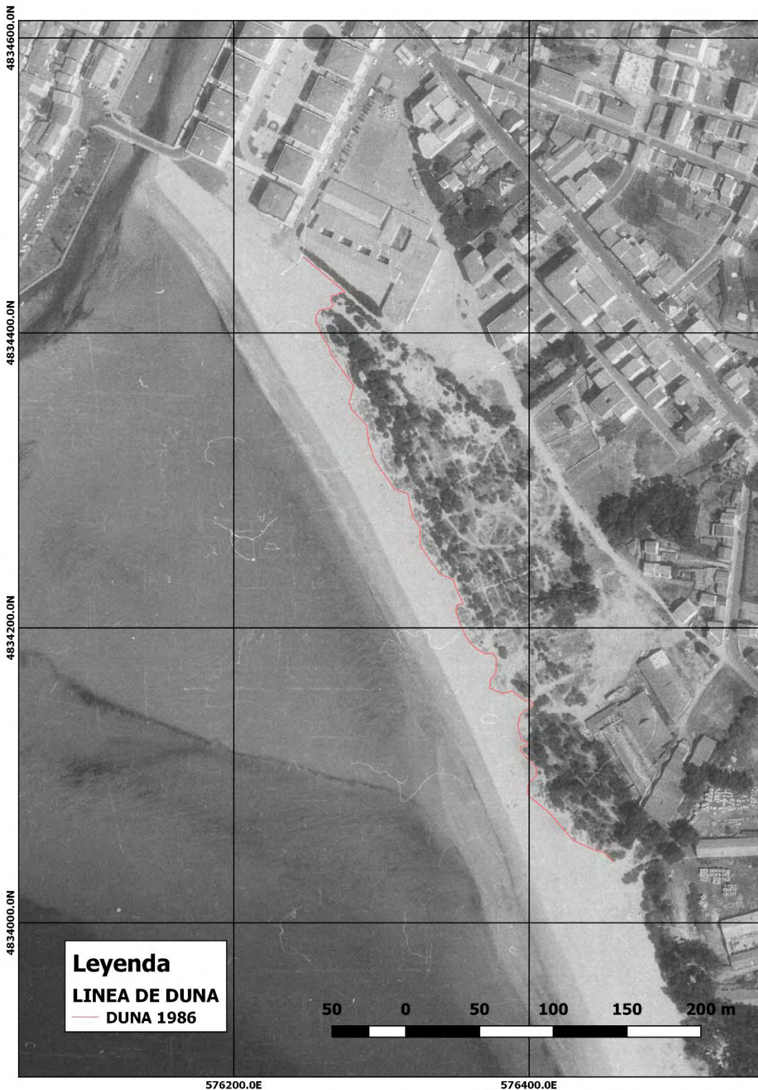
Imagen 13: Línea de borde dunar obtenida a partir de restitución del vuelo vertical Interministerial 1973-86 para la zona norte de la playa de A Magdalena, entre el río Condomiñas y el arroyo Rego da Veiga. Fuente: IGN y elaboración propia.
