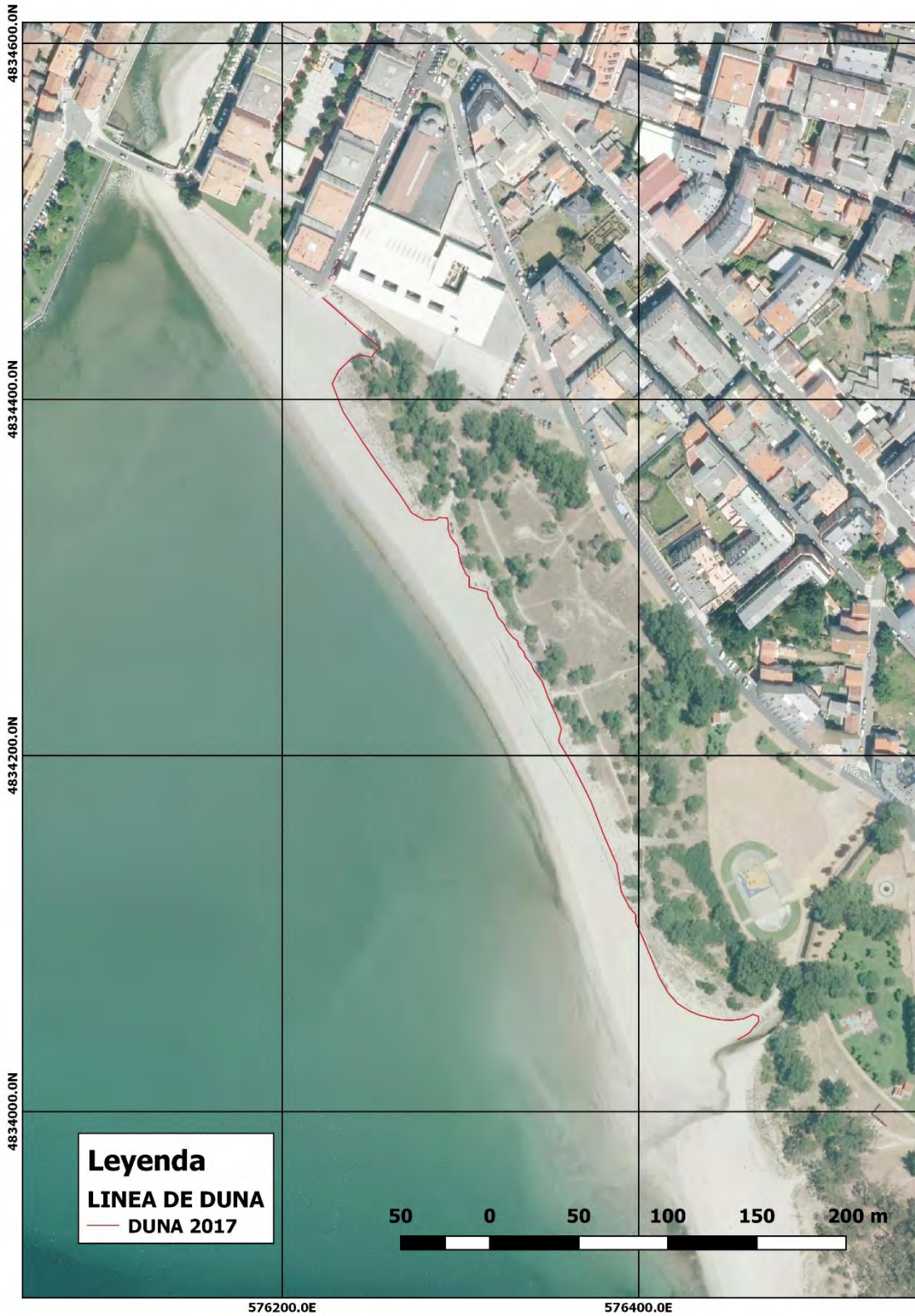
Imagen 20: Línea de borde dunar obtenida a partir de restitución del vuelo vertical PNOA 2017 para la zona norte de la playa de A Magdalena, entre el río Condomiñas y el arroyo Rego da Veiga. Fuente: IGN y elaboración propia.
