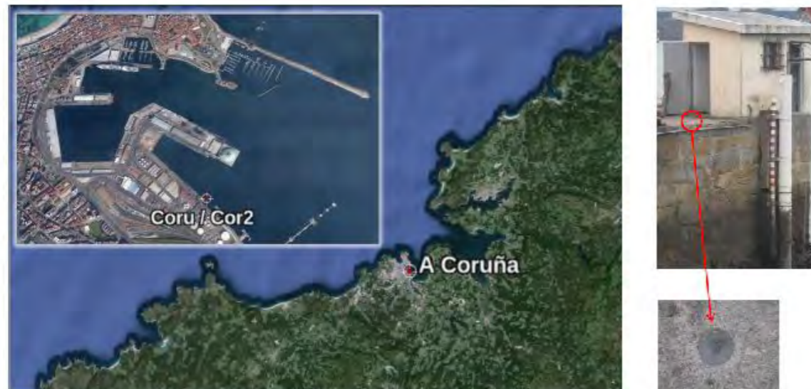
Imagen 3: Posición del mareógrafo en el Puerto de A Coruña (izda.) y fotografía de la Estación con detalle del clavo metálico (dcha.). Fuente: REDMAR.
