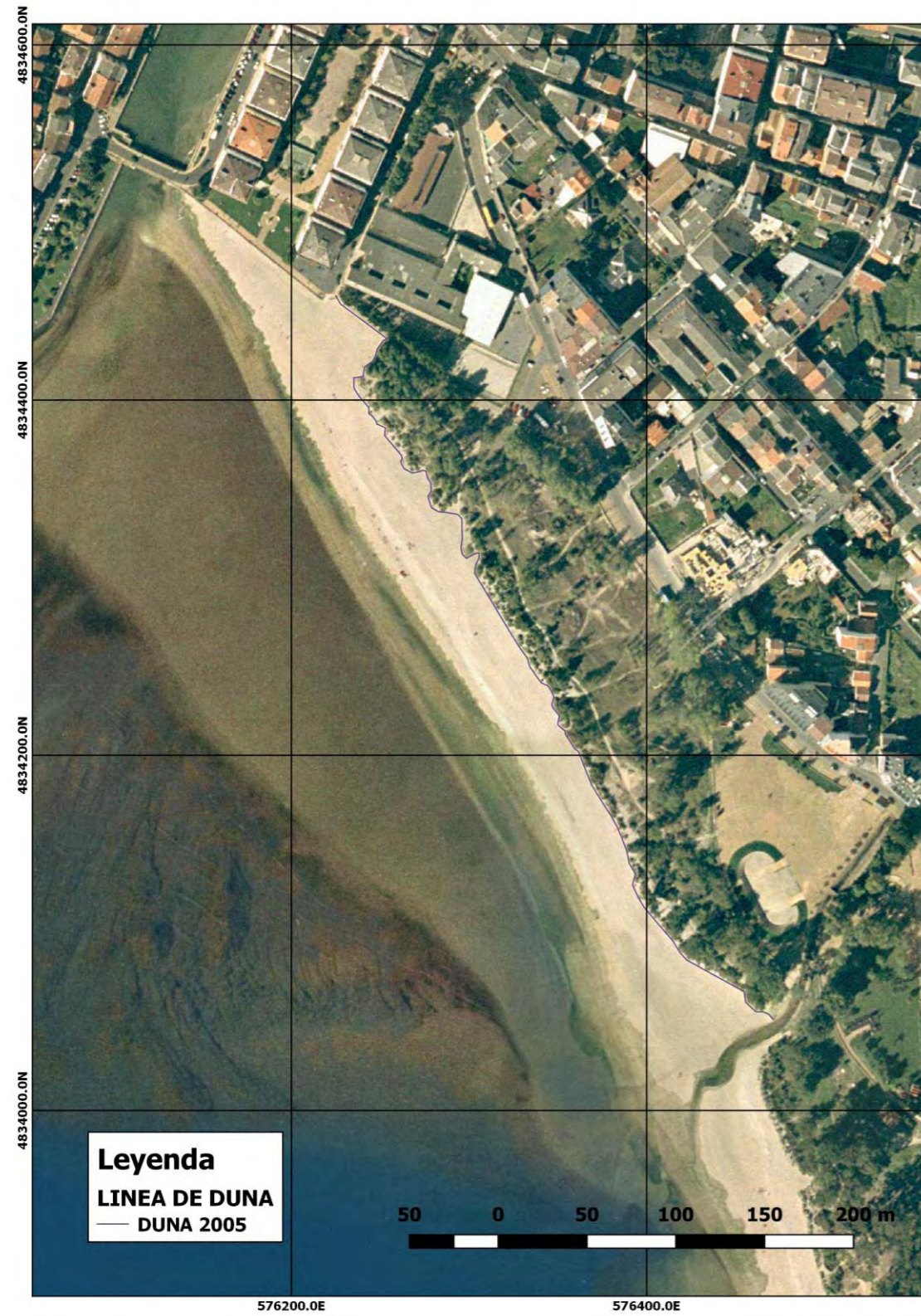
Imagen 9: Línea de borde dunar obtenida a partir de restitución del vuelo vertical PNOA 2005 para la zona norte de la playa de A Magdalena, entre el río Condomiñas y el arroyo Rego da Veiga. Fuente: IGN y elaboración propia.
