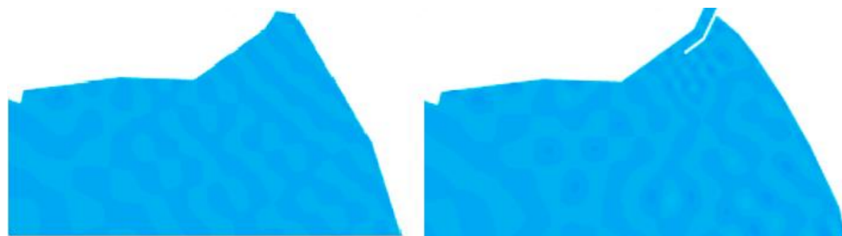
Imagen 18: Comparación entre los mapas de superficie libre del Caso 1 (condiciones medias del W) de la situación actual y de la Alternativa 1. Fuente: Elaboración propia.
