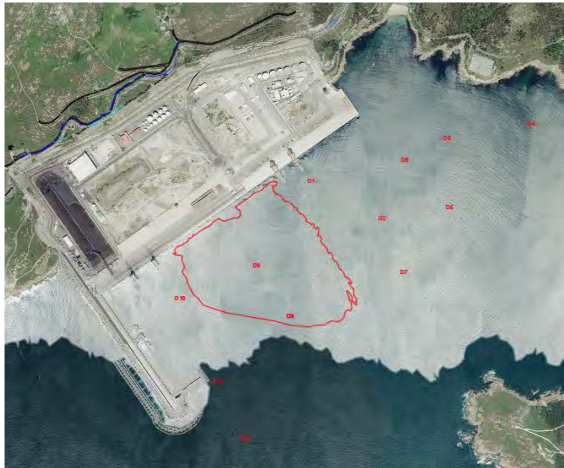
Imagen 4. Plano de situación del muestreo sedimentológico de la dársena del Puerto exterior de Ferrol VS superficie a dragar. Fuente: Control bionómico y sedimentológico durante la ejecución del proyecto de ampliación del puerto de Ferrol del año 2009 (en adelante Control bionómico y sedimentológico 2009)
