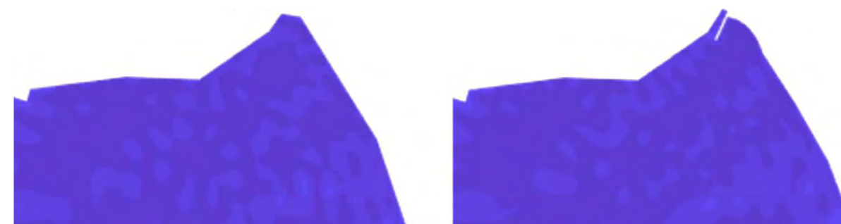
Imagen 78: Comparación entre los mapas de iso-altura de ola del Caso 4 (condiciones de temporal del WNW) de la situación actual y de la Alternativa 2. Fuente: Elaboración propia.
