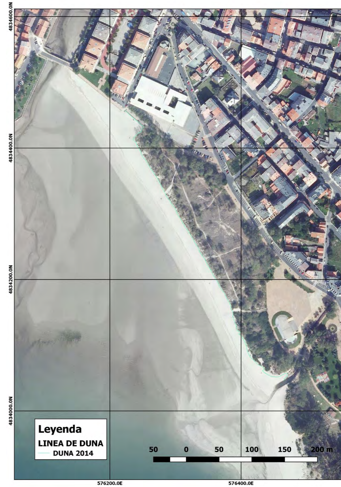
Imagen 12: Línea de borde dunar obtenida a partir de restitución del vuelo vertical PNOA 2014 para la zona norte de la playa de A Magdalena, entre el río Condomiñas y el arroyo Rego da Veiga. Fuente: IGN y elaboración propia.
