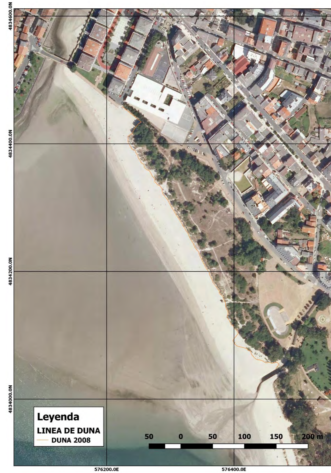
Imagen 10: Línea de borde dunar obtenida a partir de restitución del vuelo vertical PNOA 2008 para la zona norte de la playa de A Magdalena, entre el río Condomiñas y el arroyo Rego da Veiga. Fuente: IGN y elaboración propia.
