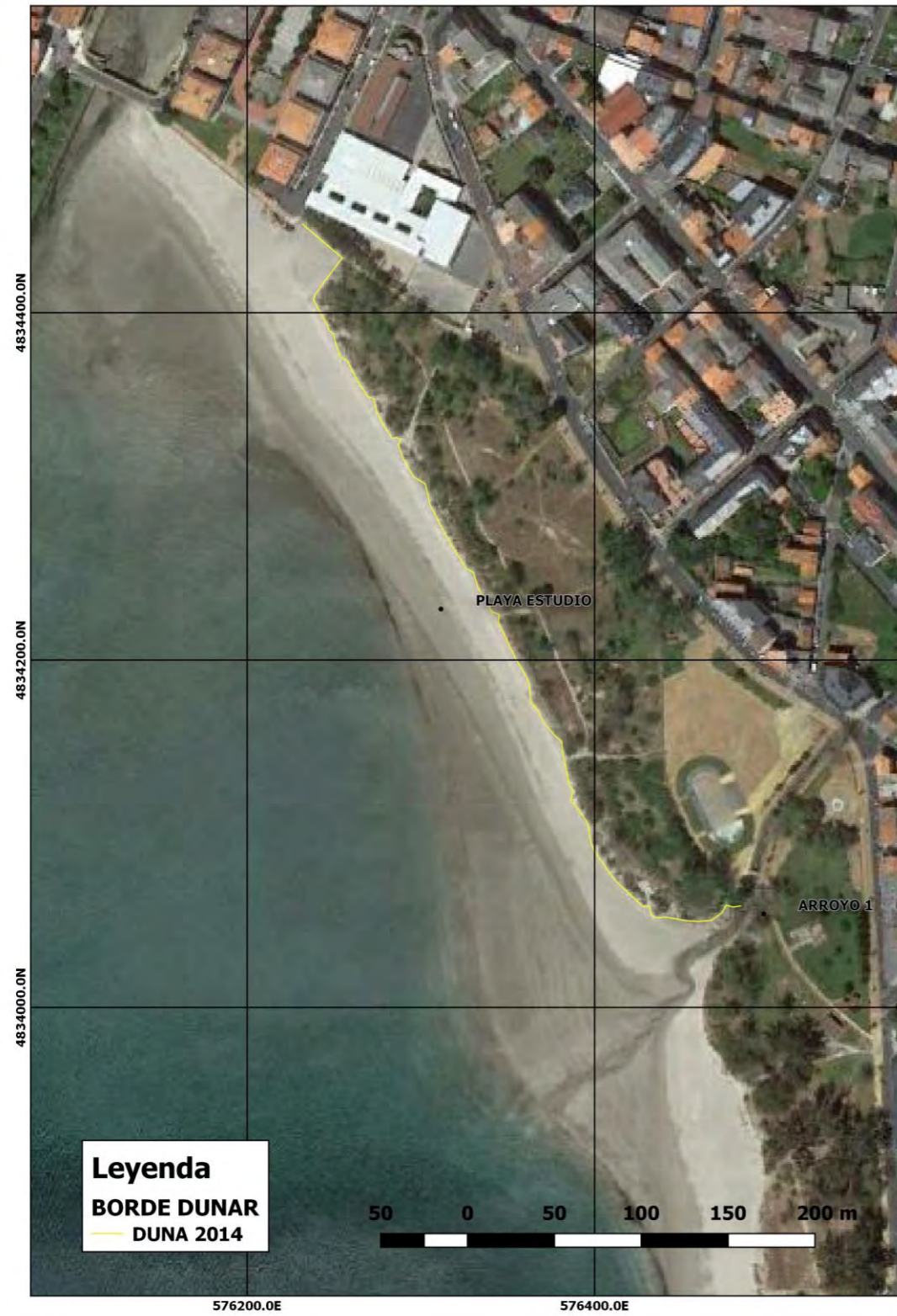
Imagen 20: Línea de borde dunar del año 2014 a partir de la digitalización de la imagen satelital de Google Earth para la zona norte de la playa de A Magdalena, entre el río Condomiñas y el arroyo Rego da Veiga. Fuente: Elaboración propia.
