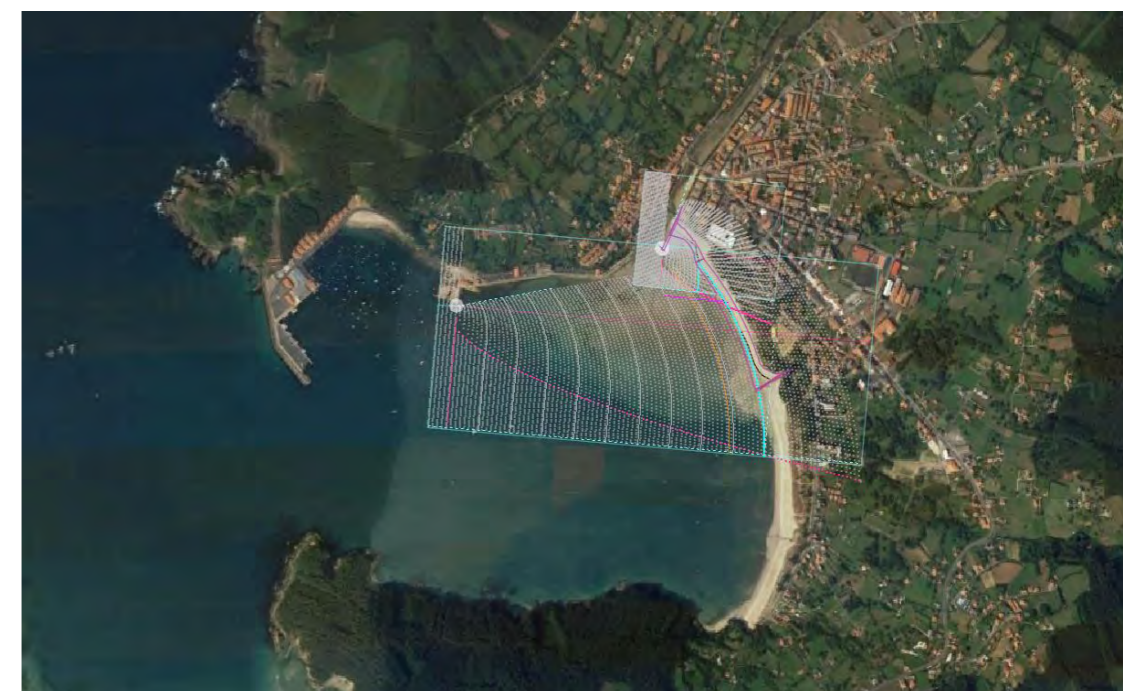
Imagen 160: Forma en planta de equilibrio de la alternativa seleccionada en SMC con el flujo medio de energía considerado. Fuente: Elaboración propia.
