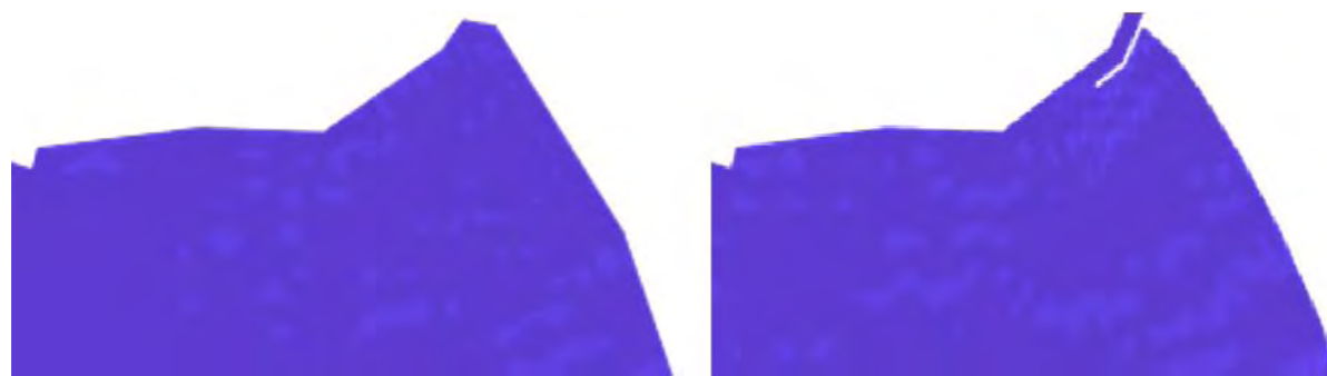
Imagen 19: Comparación entre los mapas de iso-altura de ola del Caso 1 (condiciones medias del W) de la situación actual y de la Alternativa 1. Fuente: Elaboración propia.
