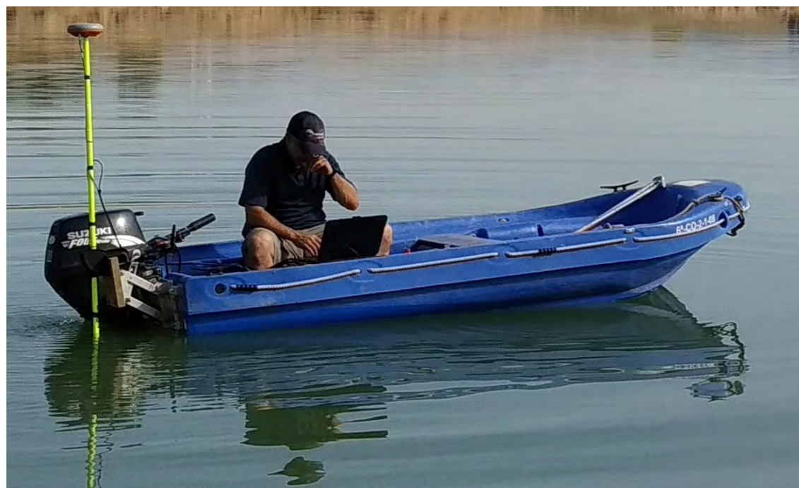
Imagen 4: Embarcación Fun Yak Secu12 con la ecosonda monohaz y el GNSS montados en el espejo de popa. Fuente: Nautilus Oceanica.
