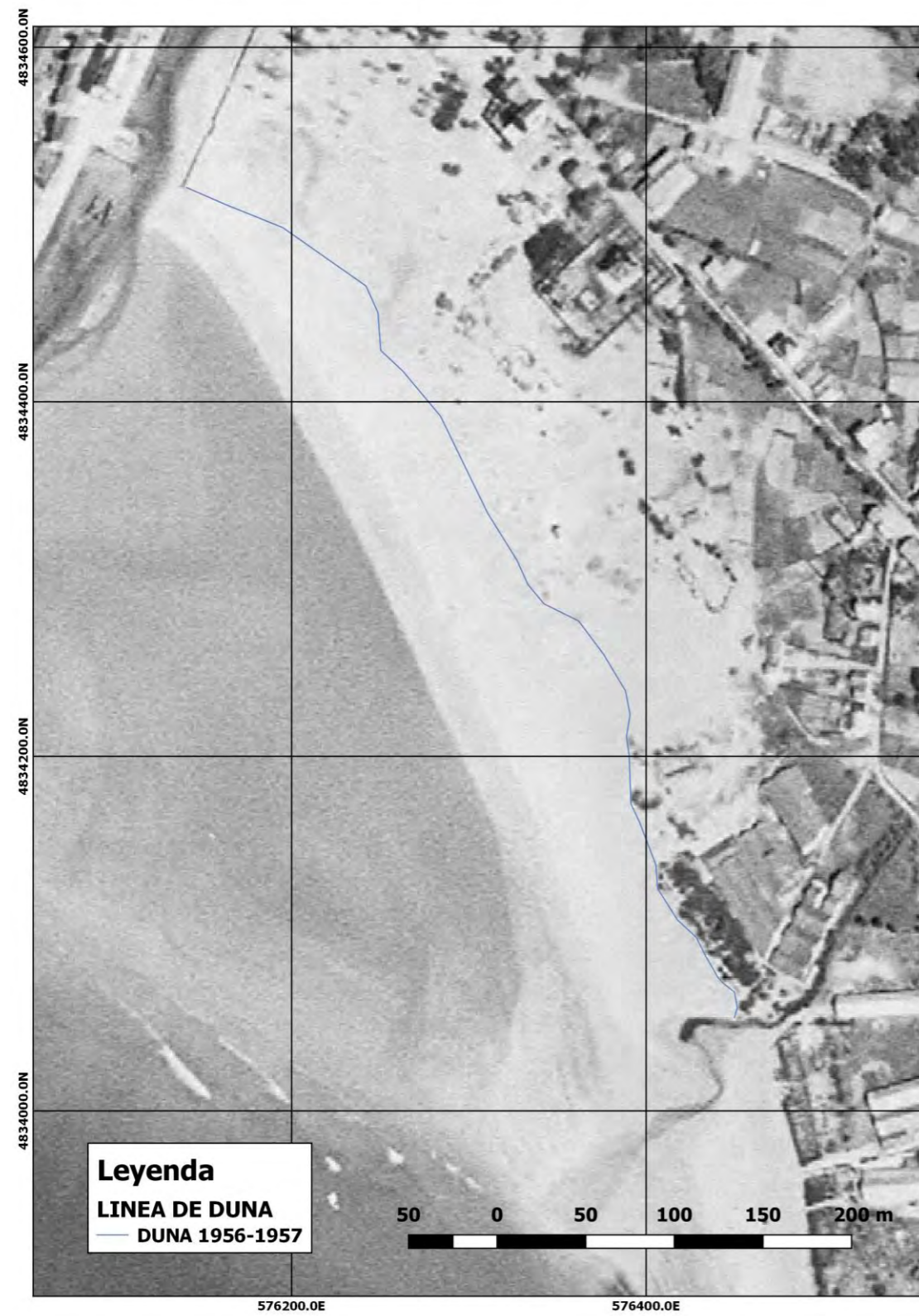
Imagen 3: Línea de borde dunar obtenida a partir de restitución del vuelo vertical Americano 1956-57 para la zona norte de la playa de A Magdalena, entre el río Condomiñas y el arroyo Rego da Veiga. Fuente: IGN y elaboración propia.
