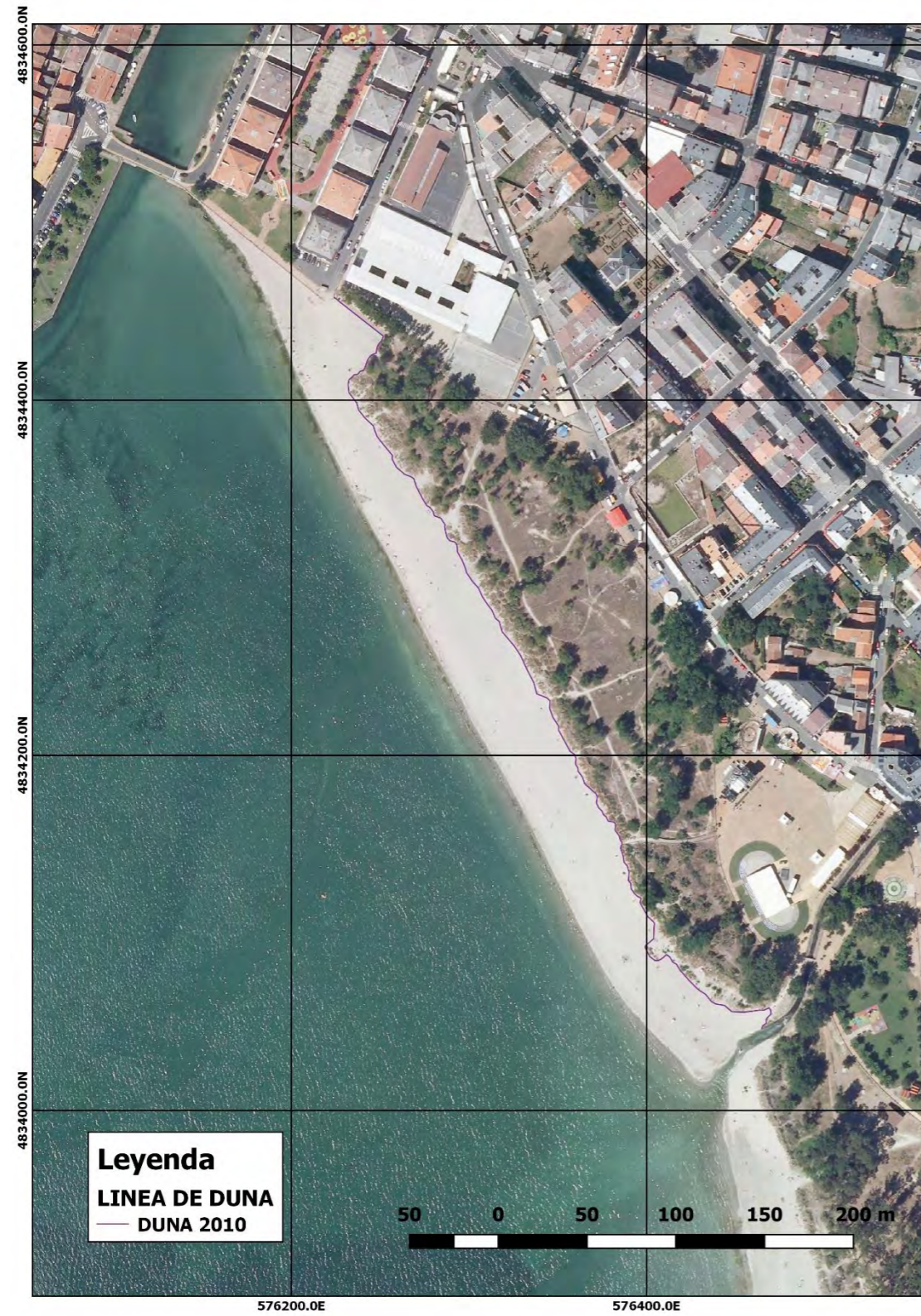
Imagen 11: Línea de borde dunar obtenida a partir de restitución del vuelo vertical PNOA 2010 para la zona norte de la playa de A Magdalena, entre el río Condomiñas y el arroyo Rego da Veiga. Fuente: IGN y elaboración propia.
