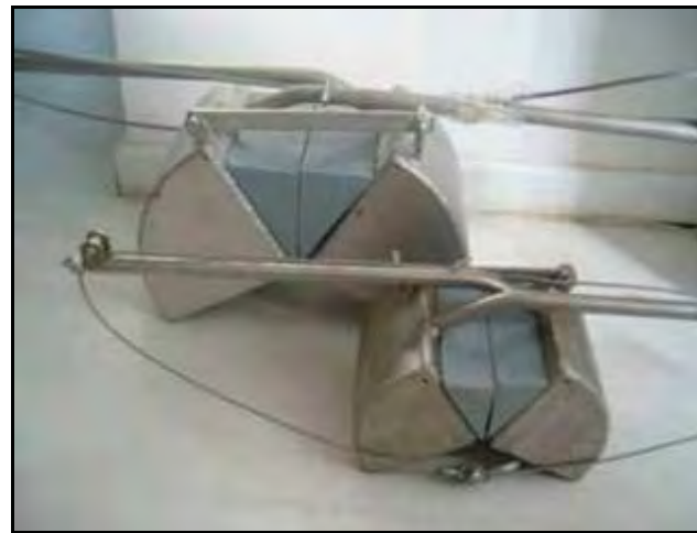
Figura 6.- Draga Van Veen para muestreo de comunidades bentónicas sobre fondos sedimentarios
