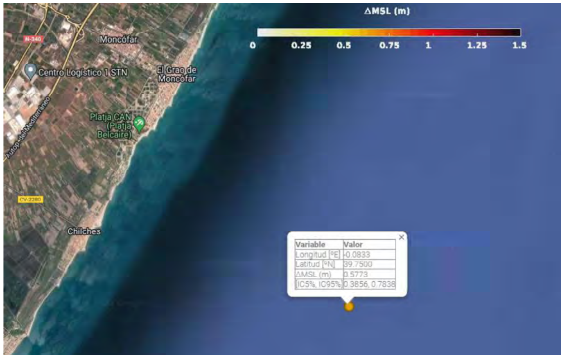
Imagen 6: Ejemplo de obtención de la proyección del NMM en el periodo 2081-2100 en el escenario RCP 8.5. Fuente: Visor C3E.
