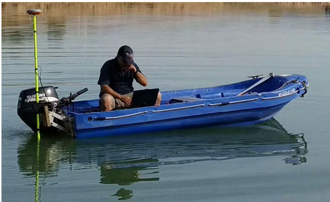
Imagen 3: Embarcación Fun Yak Secu12 con la ecosonda monohaz y el GNSS montados en el espejo de popa. Fuente: Nautilus Oceanica.
