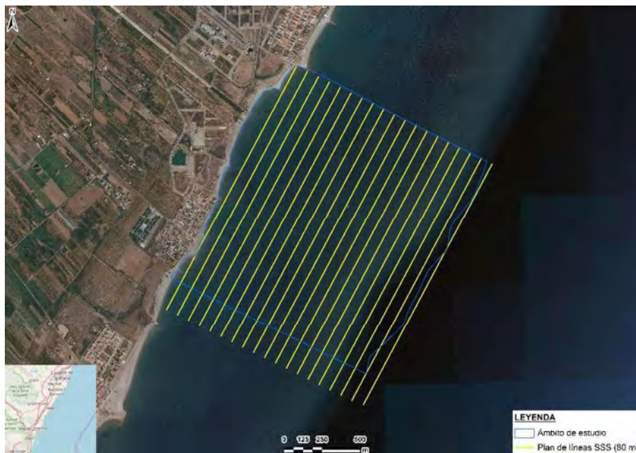
Figura 4. Plan de líneas ejecutado durante la fase de adquisición de datos de sonar de barrido lateral.
