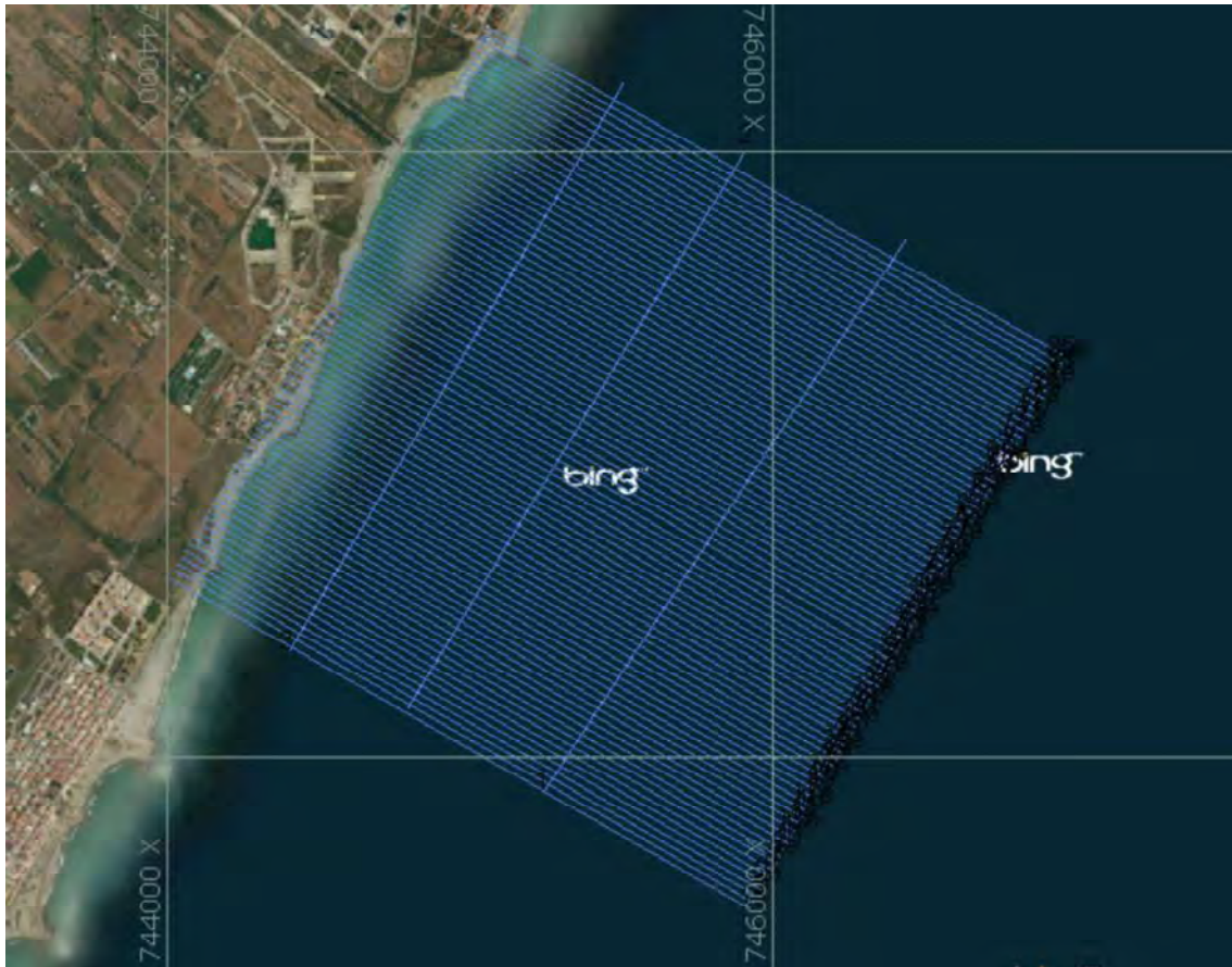
Imagen 2: Líneas de navegación programadas en Hypack en la zona de estudio. Fuente: Nautilus Oceanica.
