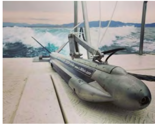
Figura 2. Modelo de sonar de barrido lateral utilizado.
