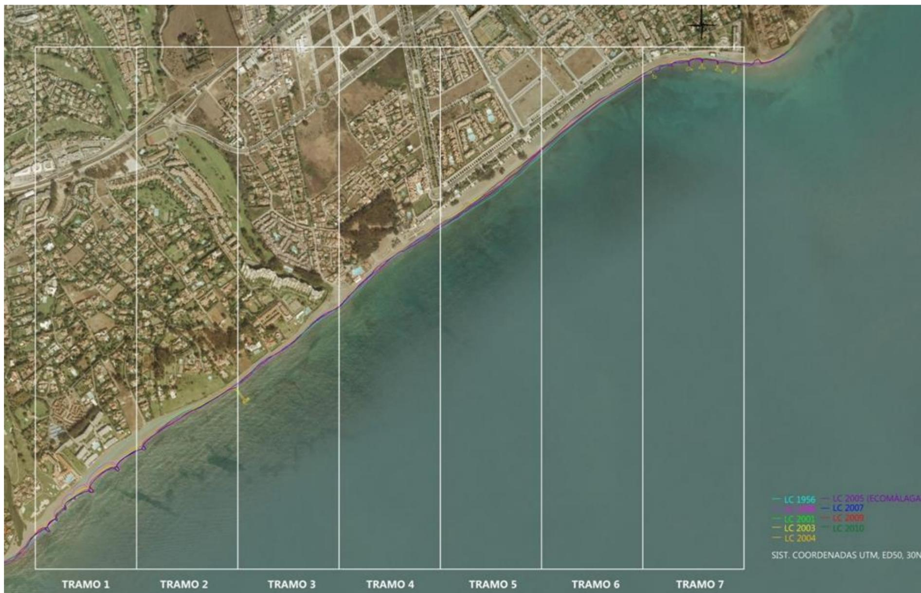
Figura 28. Tramificación del litoral en estudio para el análisis de la evolución de la línea de costa (ELC). Ortofoto de 2009.
