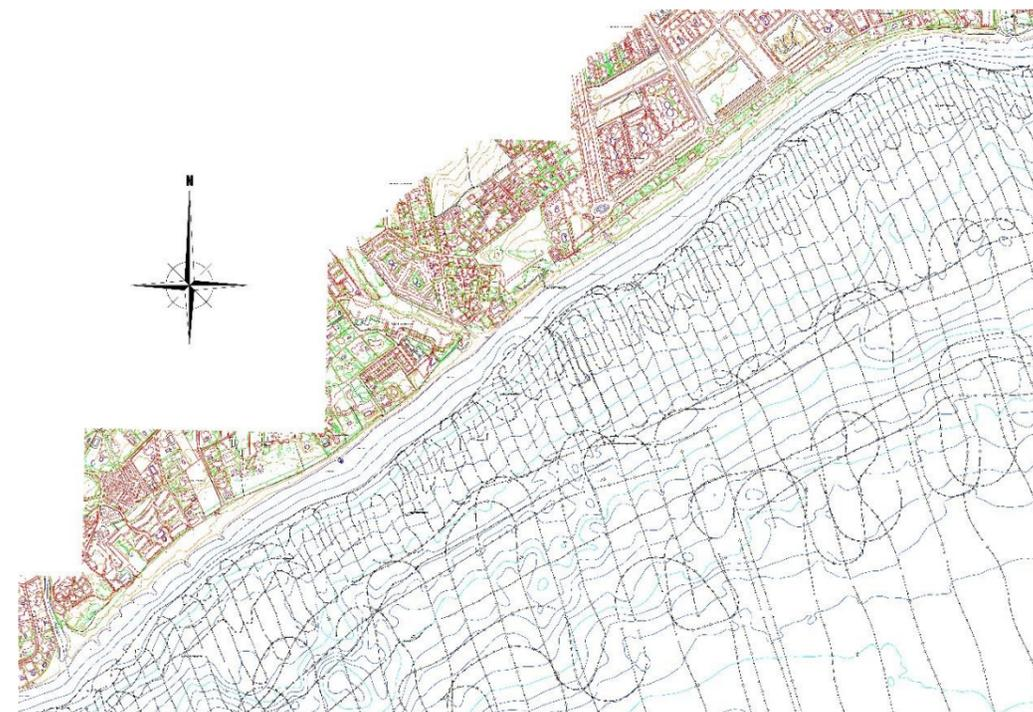
Figura 2. Recorridos seguidos por las embarcaciones para el levantamiento batimétrico del área de Proyecto.
