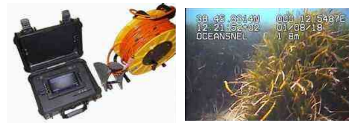
Figura 4: Equipo de TV remota georreferenciada e imagen georreferenciada obtenida. © OCEANSNELL
