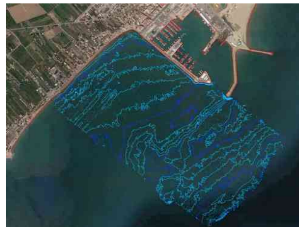
Figura 2. Vista de la batimetría y línea de costa de detalle, realizada hasta la profundidad 10 m.
