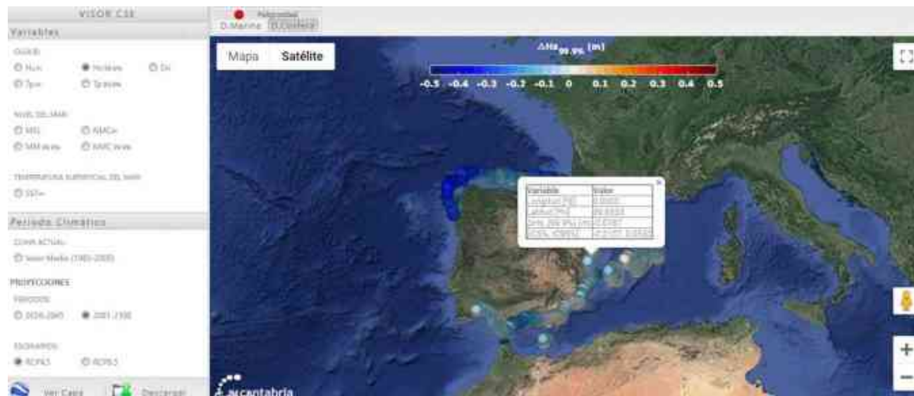
Vista del mapa de proyección a horizonte 2081-2100 de la variación de Hs99.9%, escenario RCP4.5.
