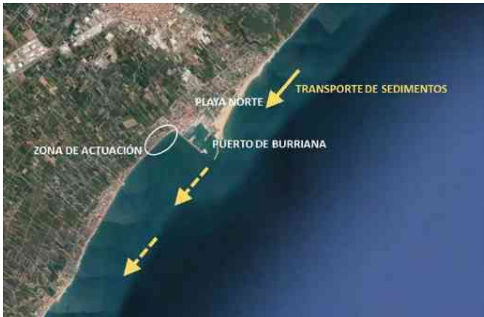
Figura 3. Vista en planta del emplazamiento. Dirección y sentido del transporte longitudinal de sedimentos.
