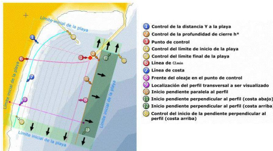
Imagen 141. Forma en planta de equilibrio. Fuente: Sistema de Modelado Costero.
