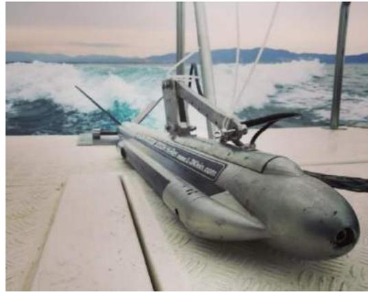
**Figura 2.** Modelo de sonar de barrido lateral utilizado.
