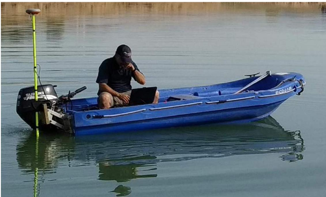
Imagen 3: Embarcación Fun Yak Secu12 con la ecosonda monohaz y el GNSS montados en el espejo de popa.
