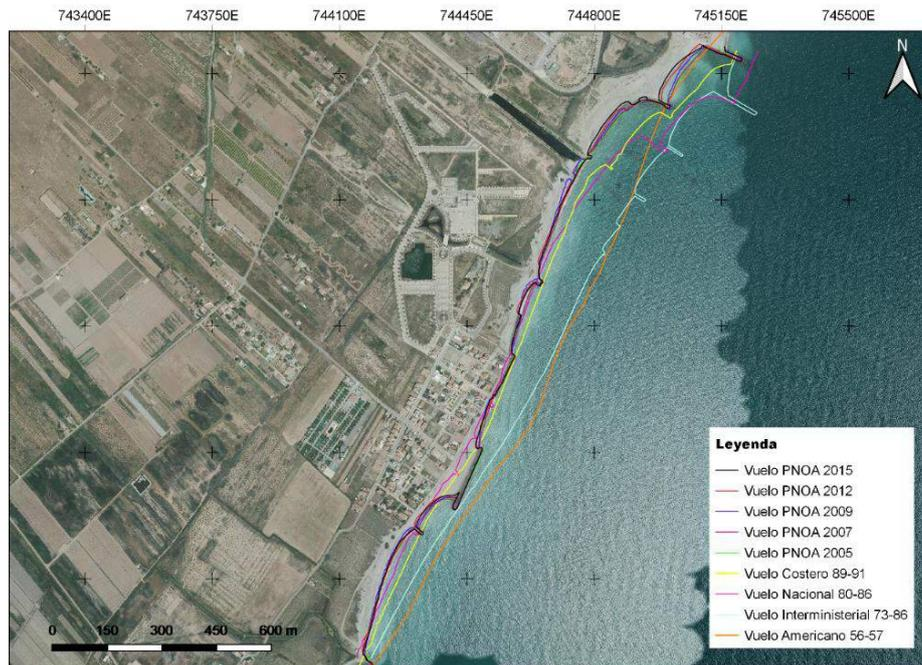
Imagen 47: Colección de líneas de costa obtenida a partir de restitución de vuelos verticales para la zona de estudio. Fuente: IGN y elaboración propia.
