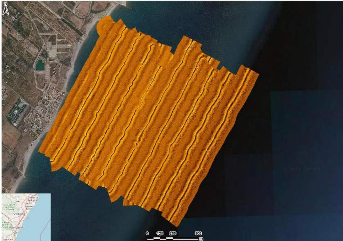
**Figura 12.** Mosaico con cobertura total a partir de los datos obtenidos mediante sonar de barrido lateral en el área de estudio.
