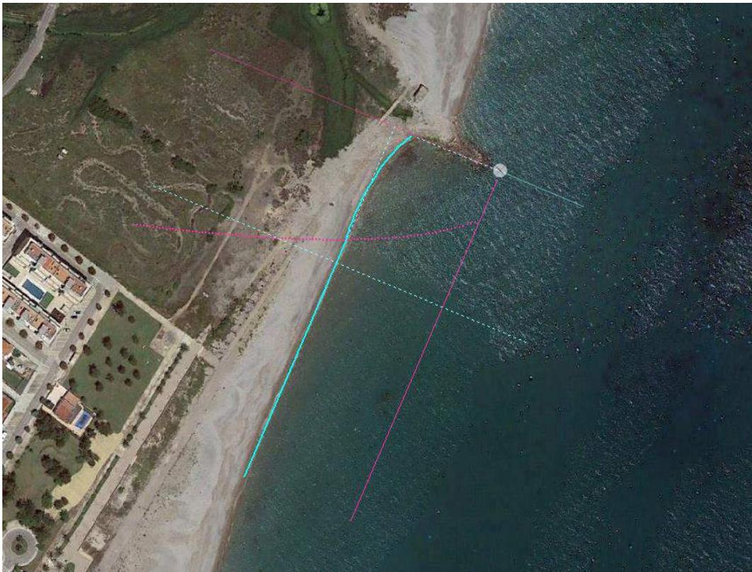
Imagen 143. Análisis de la forma en planta mediante SMC de la playa de Les Cases en la situación actual. Fuente: elaboración propia.
