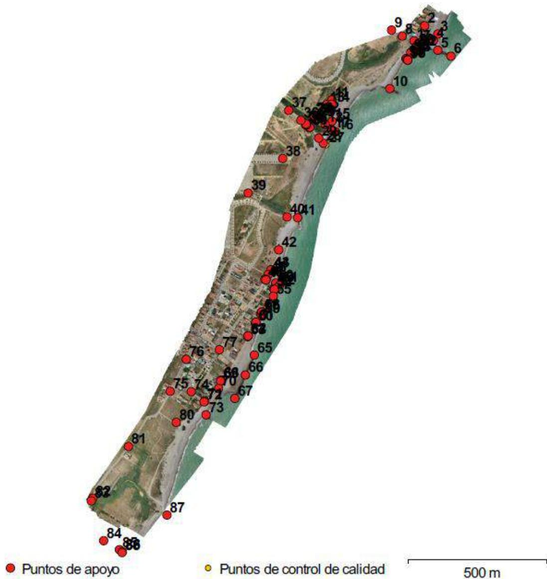
Imagen 12: Posiciones de puntos de apoyo. Fuente: GeoBIM.
