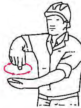
10 Bajar el aguilón o pluma y levantar la carga
