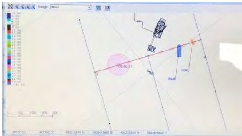
Figura 7: Sistema de posicionamiento de la embarcación y ROV sobre el transecto. (Fte. OCEANSNELL, 2020)
