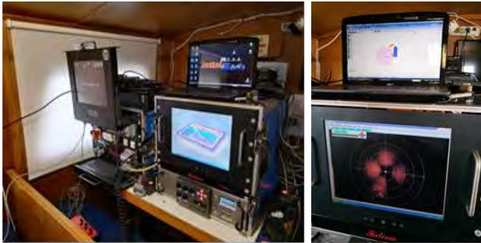
Figura 9: Montaje de superficie en cabina para el control del ROV y grabación de las imágenes. (Fte. OCEANSNELL, 2020)
