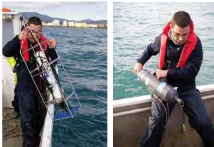
Figura 1. Sonda oceanográfica multiparamétrica CTD SBE 19 Plus v2 (izquierda) y botella hidrográfica tipo Niskin (derecha) empleado en el estudio (Fte. Oceansnell, 2020).
