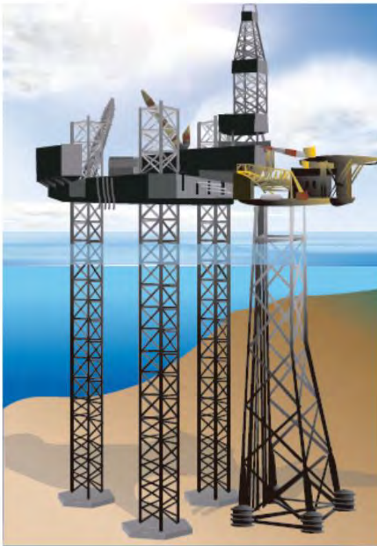
Figura 14: Jack-up junto a una plataforma fija
