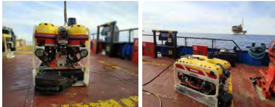
Figura 6: ROV empleado en las inspecciones. (Fte: OCEANSNELL, 2020).
