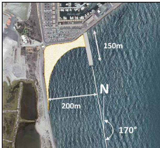
Ilustración 3. Alimentación artificial y construcción de espigón. Fuente: Actualización del proyecto de acondicionamiento de las playas de La Llana. IH Cantabria (2.020)
