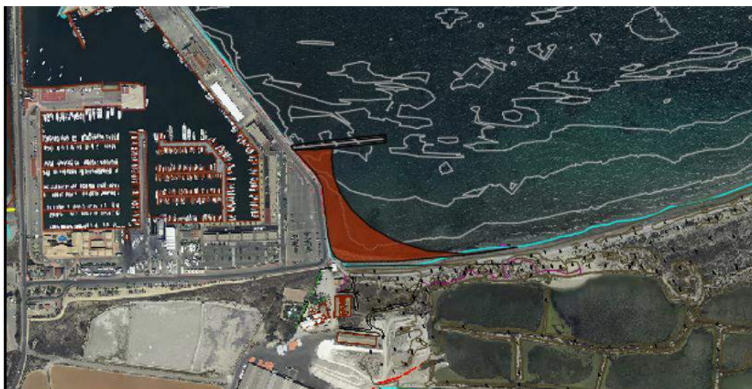
Ilustración 11. Zona de colocación de la arena
