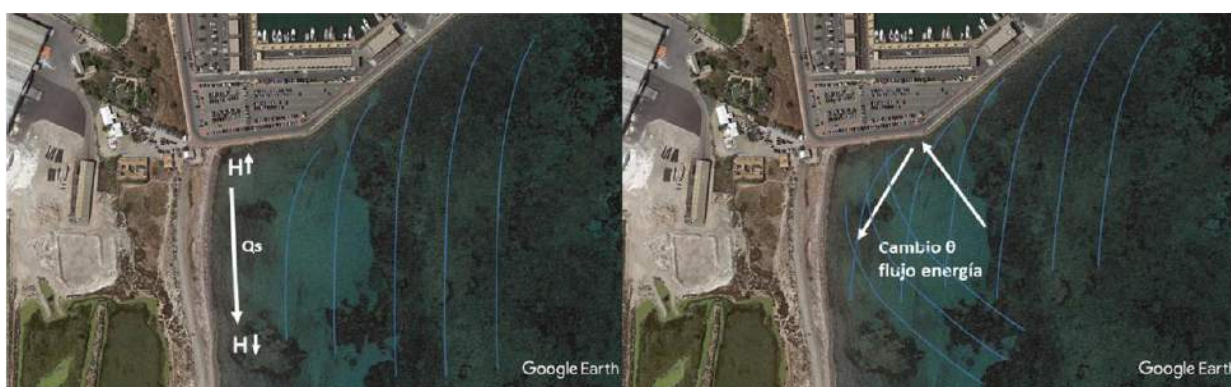
Ilustración 1. Imagen izquierda: efecto “match stem”; Imagen derecha: reflexión del oleaje y cambio de dirección del flujo de energía.
