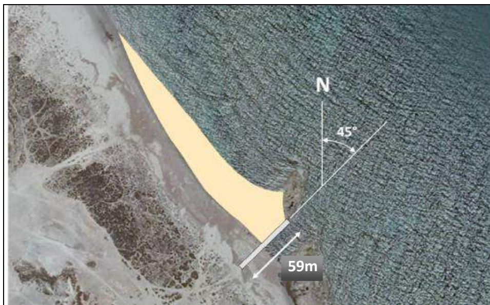
Ilustración 12. Acumulación de arena producto de la presencia del segundo espigón
