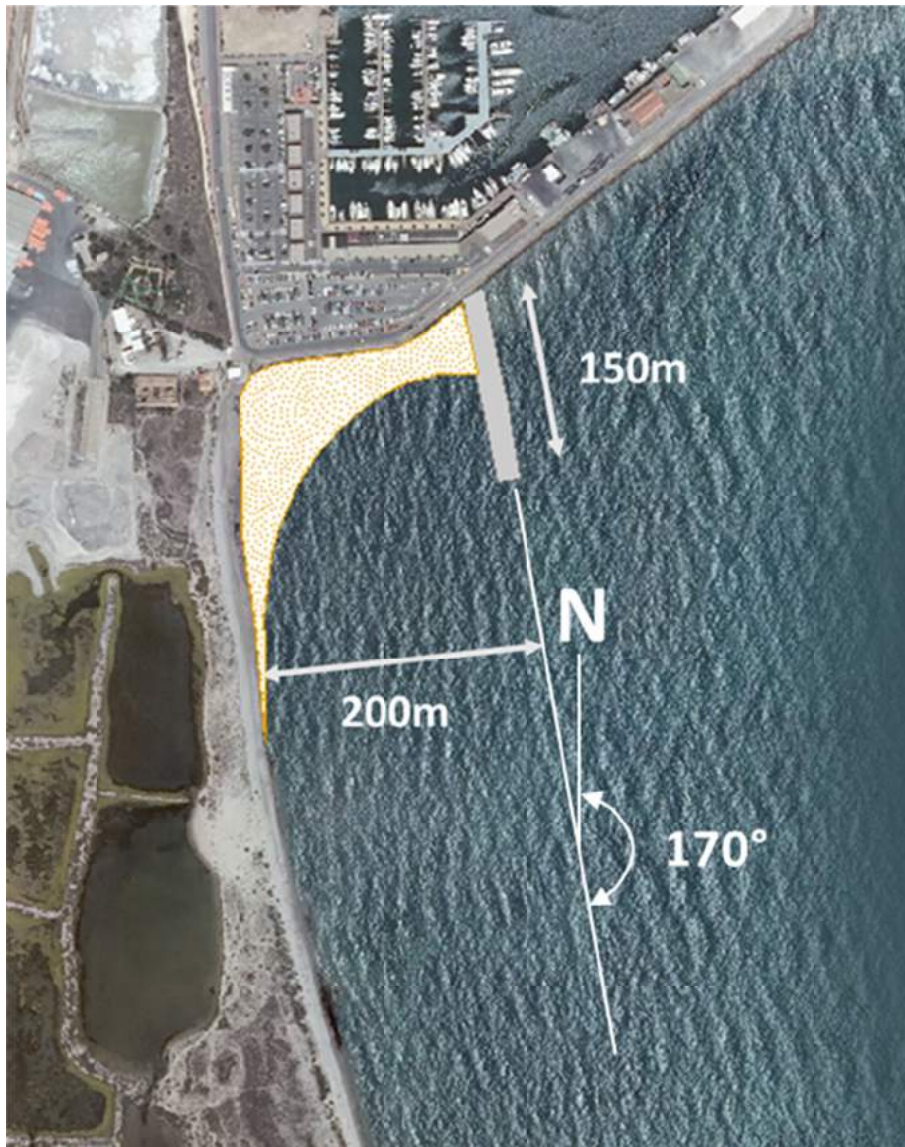
Figura 46. Alimentación artificial y construcción de un dique
