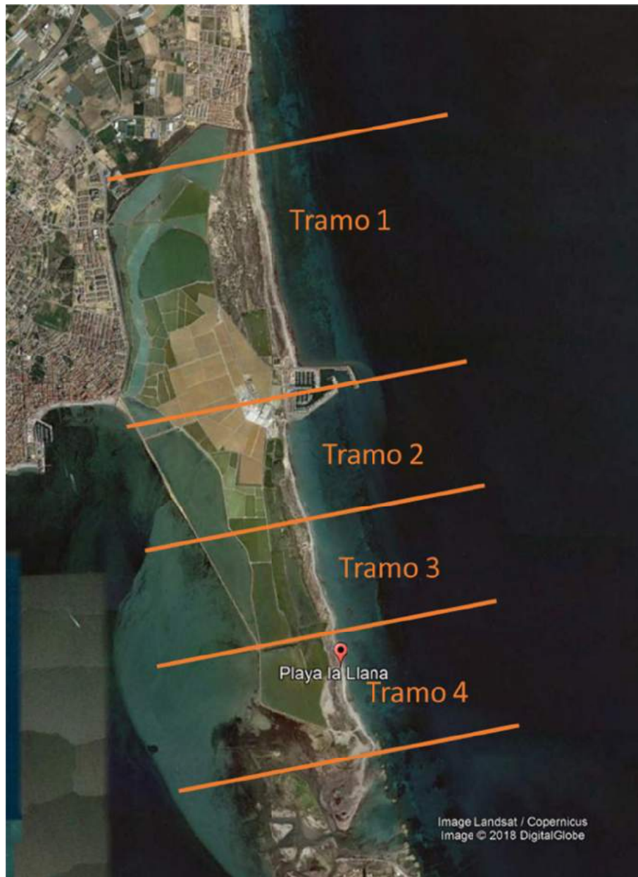
Figura 36. Tramos en los que se ha dividido la zona de estudio para el análisis de la evolución de la línea de costa
