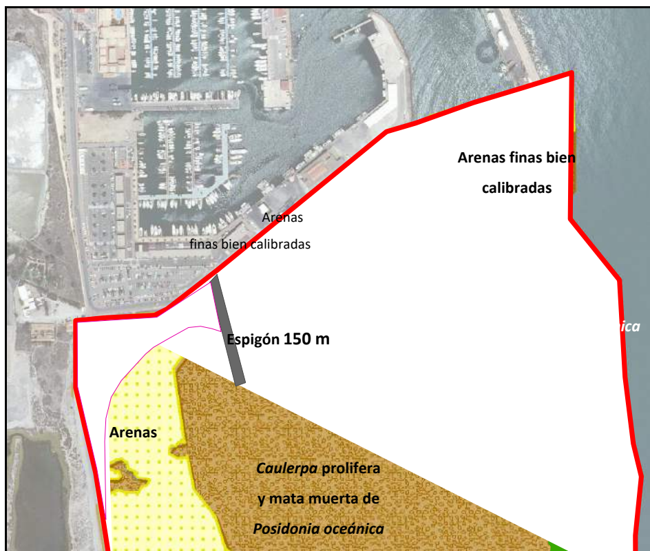
Ilustración 4. Playa estabilizada, y espigón, en relación a los hábitats subacuáticos cartografiados. Fuente: Estudios previos: Proyecto de acondicionamiento de las playas de La Llana.
