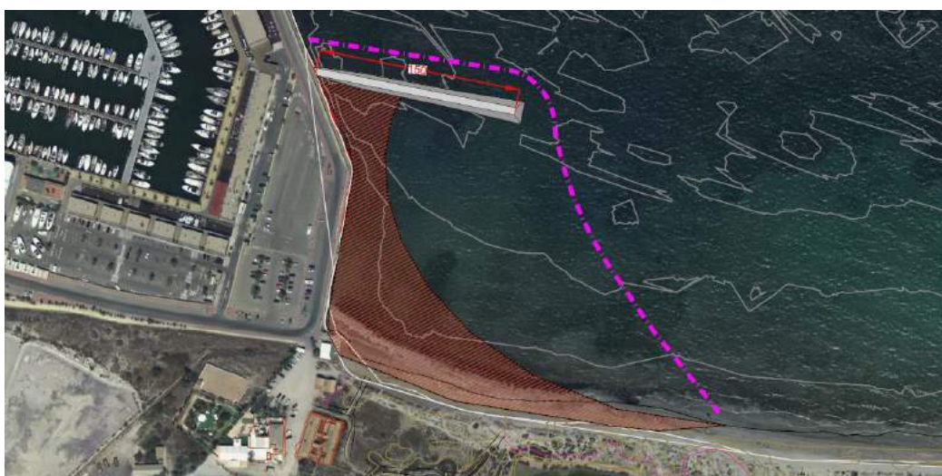
Ilustración 12. Colocación de barrera antiturbidez en espigón de 150m y playa regenerada.
