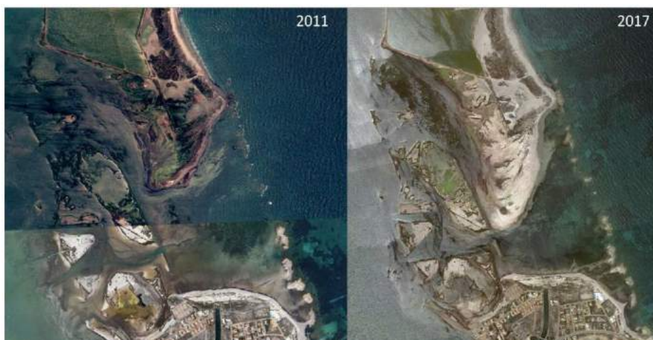
Ilustración 16. Acumulación de arena en la gola de las encañizadas
