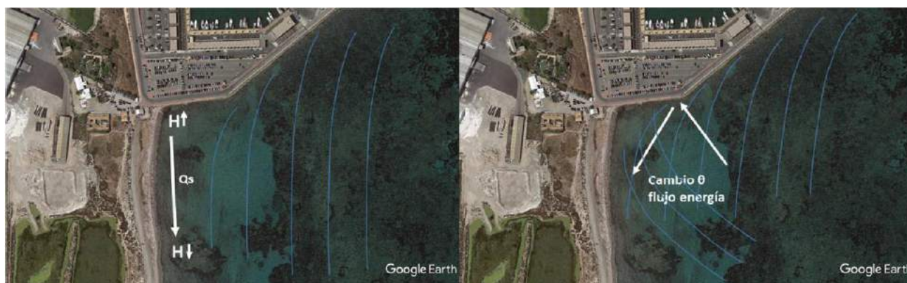
Ilustración 19. Imagen izquierda: efecto “match stem”; Imagen derecha: reflexión del oleaje y cambio de dirección del flujo de energía.
