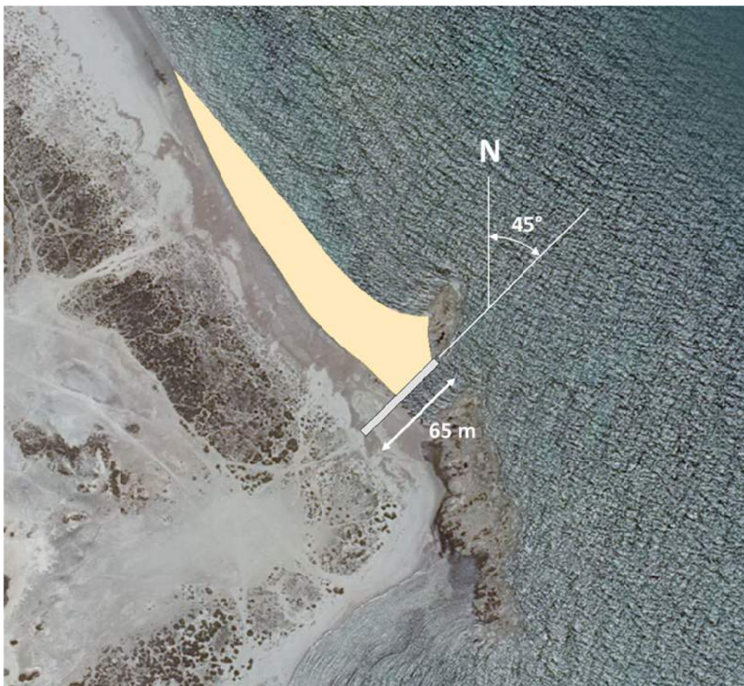
Figura 45. Forma en planta de equilibrio de la playa, límite máximo de avance de la línea de costa (zona de contención de arena).
