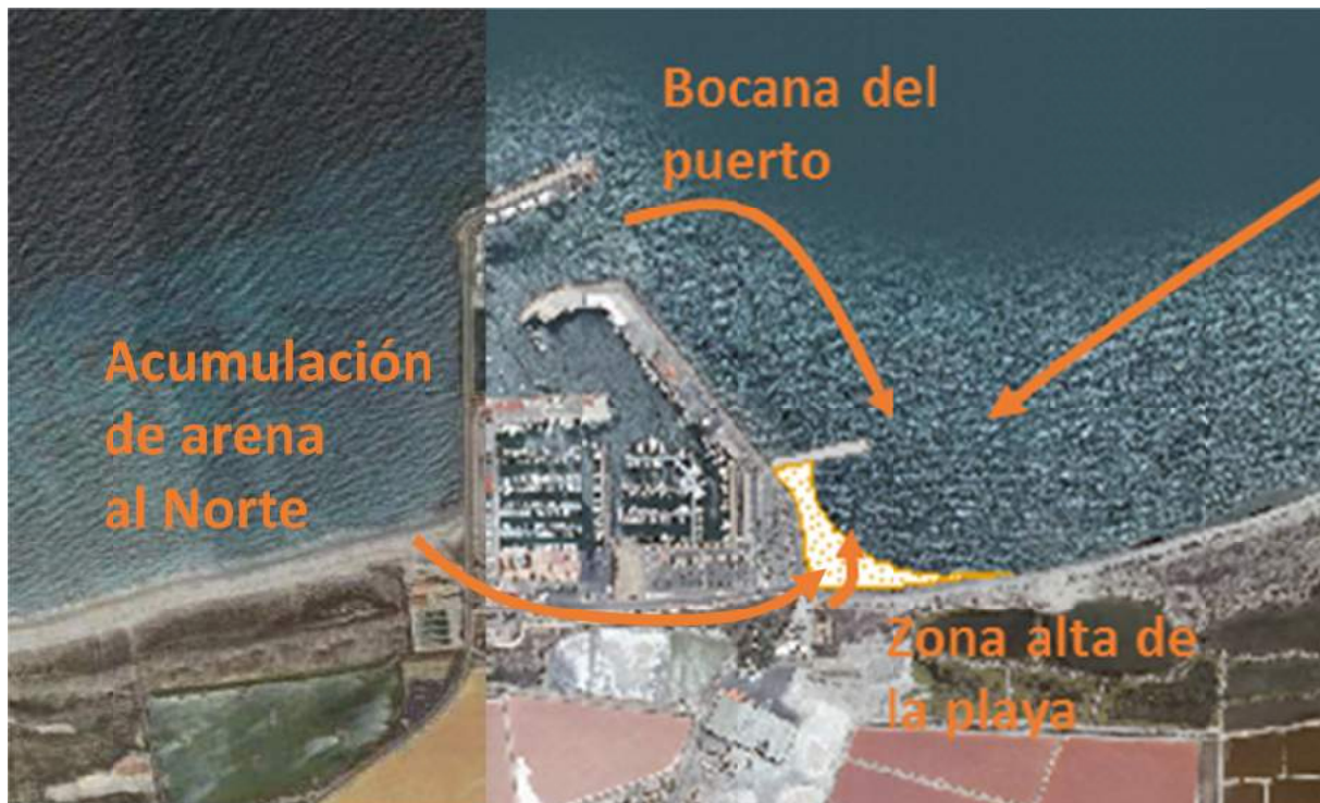
Figura 47. Procedencia del sedimento necesario para la regeneración de la playa.
