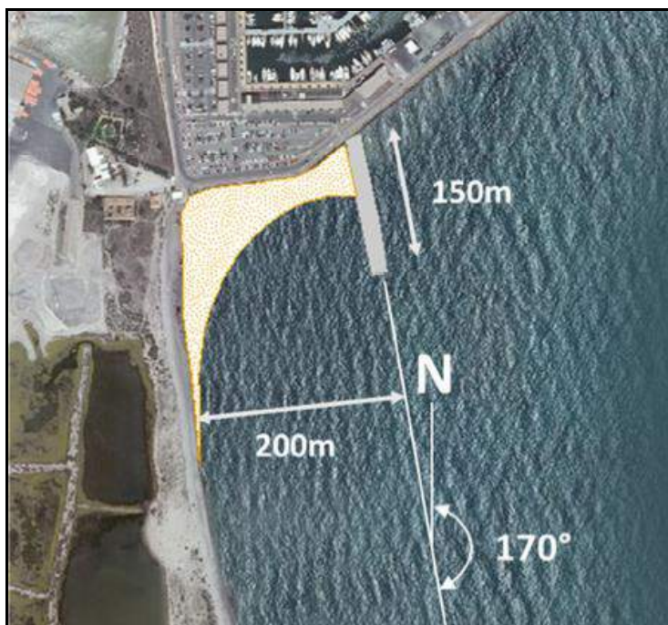
Ilustración 17. Alimentación artificial y construcción de espigón. Fuente: Actualización del proyecto de acondicionamiento de las playas de La Llana. IH Cantabria (2.020)
