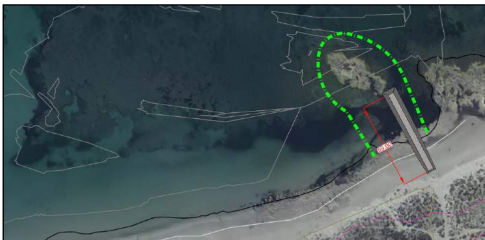
Ilustración 13. Colocación de barrera antiturbidez durante la ejecución del espigón de 59m
