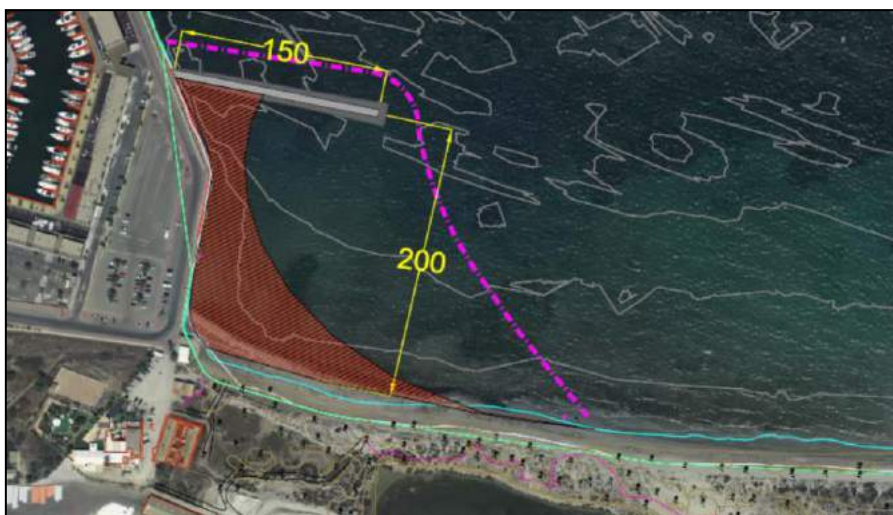
Ilustración 8. Planta de la superficie a regenerar.
