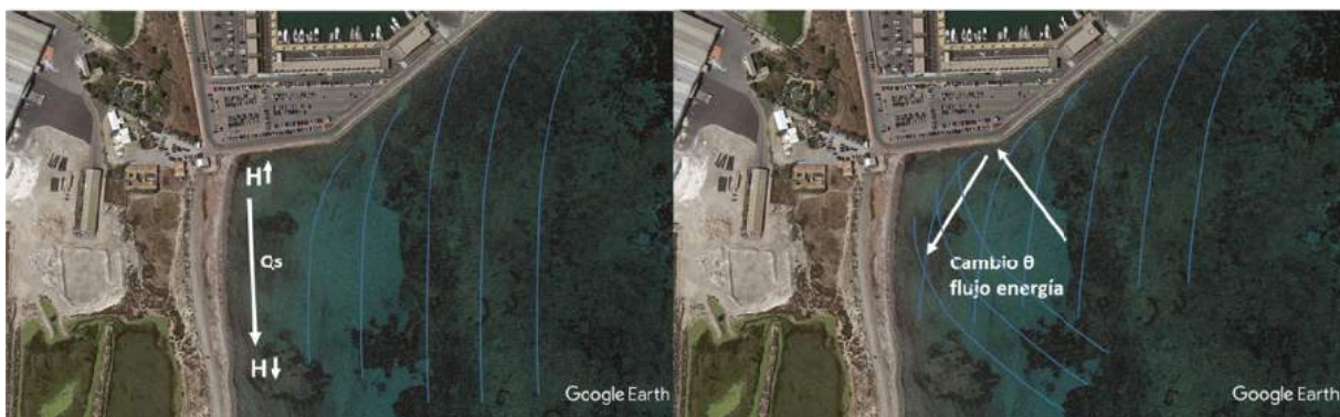
Figura 20. Imagen izquierda: efecto “match stem”; Imagen derecha: reflexión del oleaje y cambio de dirección del flujo de energía
