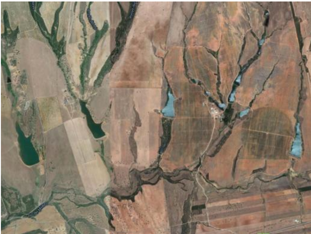
Fig.4.- Imagen de varias de las balsas para el almacenamiento de las escorrentías de los afluentes de la margen derecha del río Milagro.
