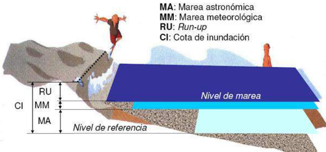
Figura 1. Factores que determinan la cota de inundación en una playa.
