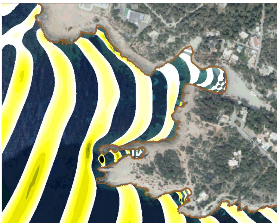
Figura 47. Frente de oleaje para el Estado Final en el instante t=8 s
