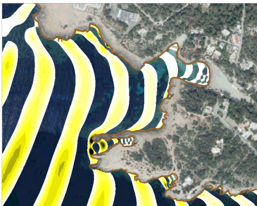
Figura 49. Frente de oleaje para el Estado Final en el instante t=20 s
