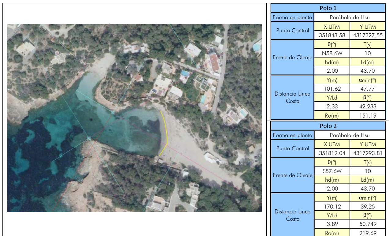
Figura 38. Ajuste de planta de equilibrio de Cala Gració. Polos de difracción y líneas de Alamin.
