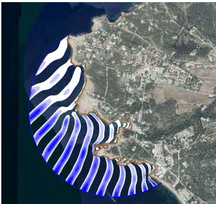
Figura 44. Frente de oleaje para el estado inicial y en el instante t=11 s
