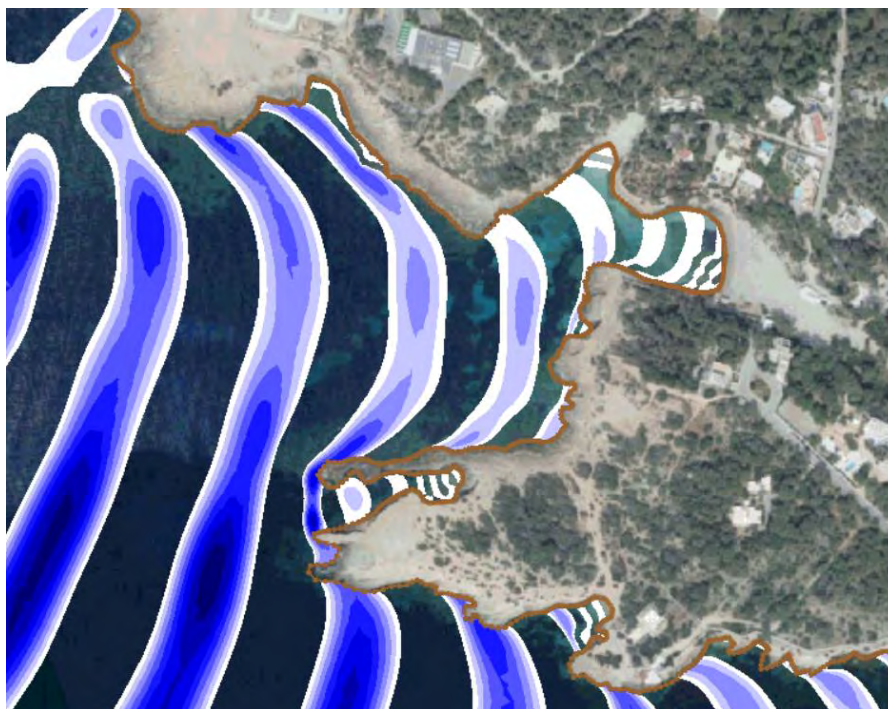
Figura 48. Frente de oleaje para el Estado Actual en el instante t=20 s
