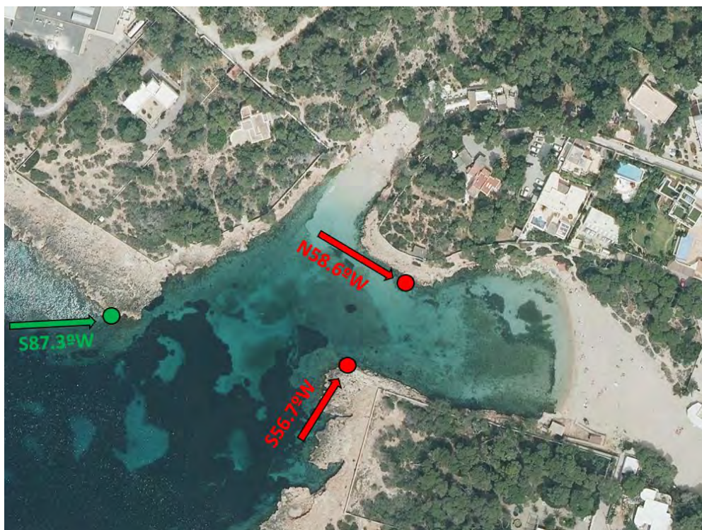
Figura 40. Flujo de energía en los polos de difracción. Cala Gracioneta (verde) y Cala Gració (rojo)
