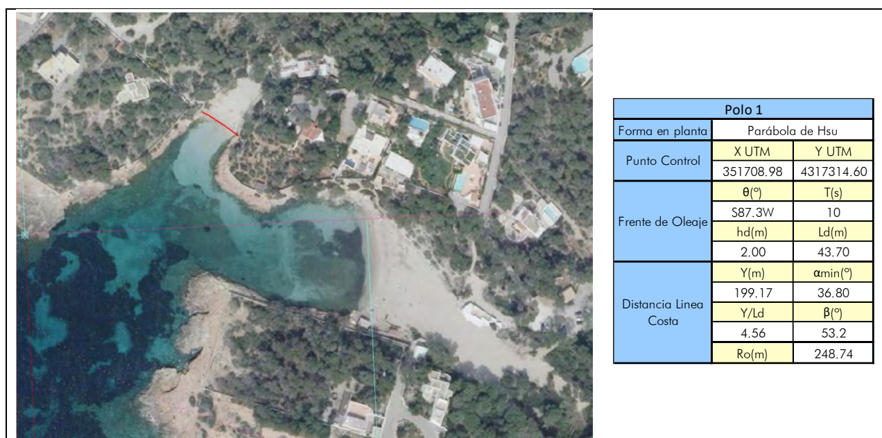
Figura 39. Ajuste de planta de equilibrio de Cala Gracioneta. Polo de difracción y línea de Alamin.
