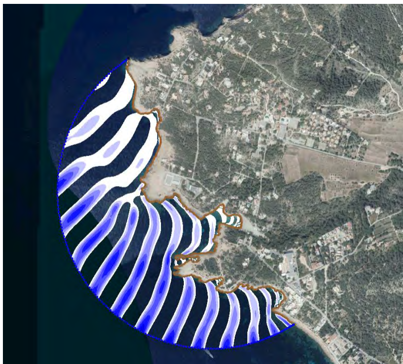
Figura 42. Frente de oleaje para el estado inicial y en el instante t=5 s
