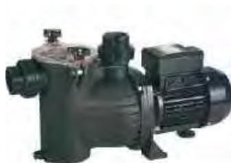
BOMBA PARA FILTRACIÓN SACS OPTIMA 75M CON MOTOR 0.55kW A 1x230V-50Hz SOBRE BANCADA
