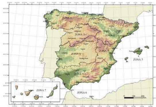
FIGURA 4.3-b) ZONAS CLIMÁTICAS DE INVIERNO (Coincide con el mapa correspondiente del Código Técnico de la Edificación)
