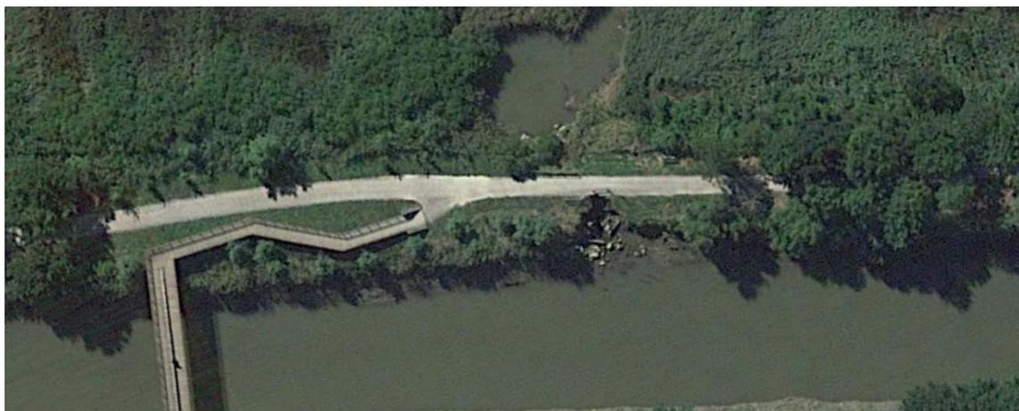
El paso de un mayor caudal por el paso subterráneo ha motivado la erosión paulatina de de parte de los bordes del terreno, la desaparición del extremo oriental del conducto y la consecuente afección al camino que transita de sur a norte por la margen derecha del corte de la ría. Esta circunstancia motivo en el año 2015, a raíz de una denuncia de la demarcación de Costas del País Vasco, la colocación de un vallado en la zona para evitar
