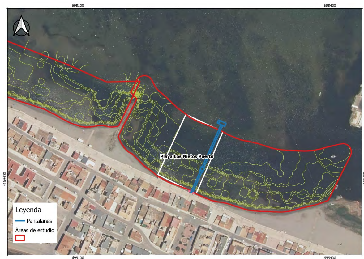
Figura 12. Ubicación final proyectada del pantalán flotante en la playa de Los Nietos Puerto en relación con la propuesta de ubicación analizada en base a batimetría y a la minimización de daños a la biocenosis.
