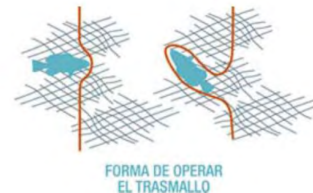
Figura 95. Esquema de la forma de operar del trasmallo.
