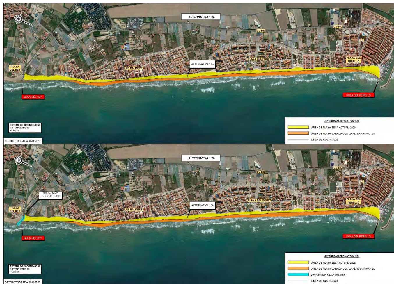
Figura 5. Subalternativas 1.2.a (Superior) y 1.1.b (Inferior). Regeneración de la playa mediante aporte exclusivo de arena hasta obtener unos avances de la línea de costa superiores a los existentes en el año 1965 (avance de 22 metros de media).
