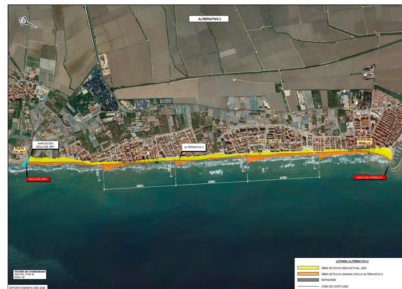
Figura 6. Alternativa 2. Regeneración de la playa mediante espigones transversales, que reducen el transporte longitudinal y retienen la arena.
