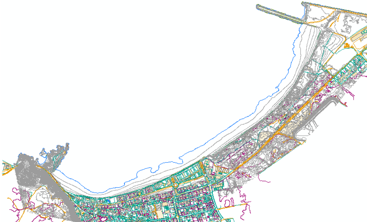
Figura 3. Ortofoto y cartografía a escala 1:5 000 obtenida como resultado del vuelo drone realizado en el mes mayo de 2016.
