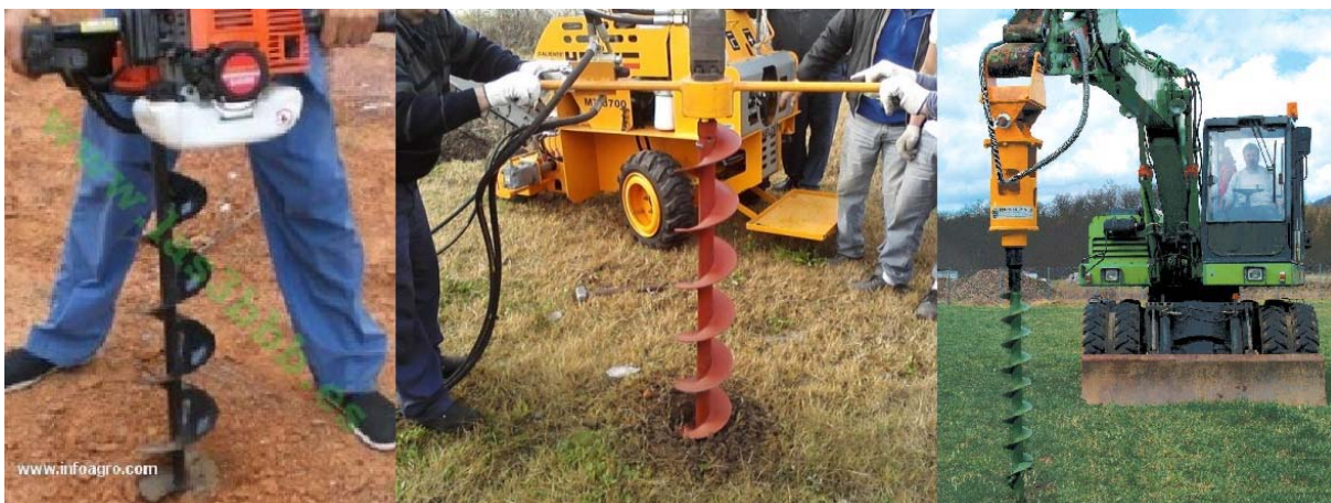
Fotos 19 a 21. "Mini" con barrena hoyadora (derecha), y hoyadora manual, para colocación de postes.
