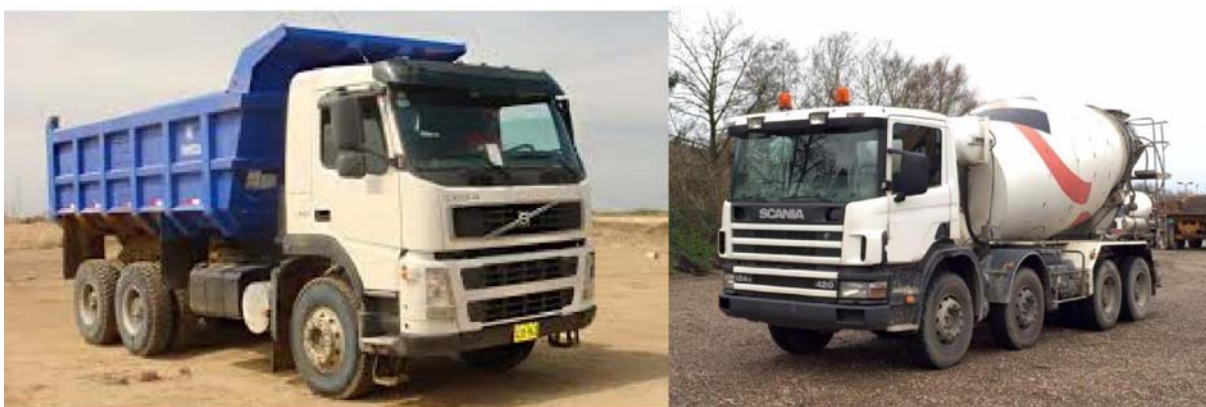
Fotos 22 y 23. Camión volquete (izquierda) para carga de materiales, y camión hormigonera para el relleno de zanjas.
