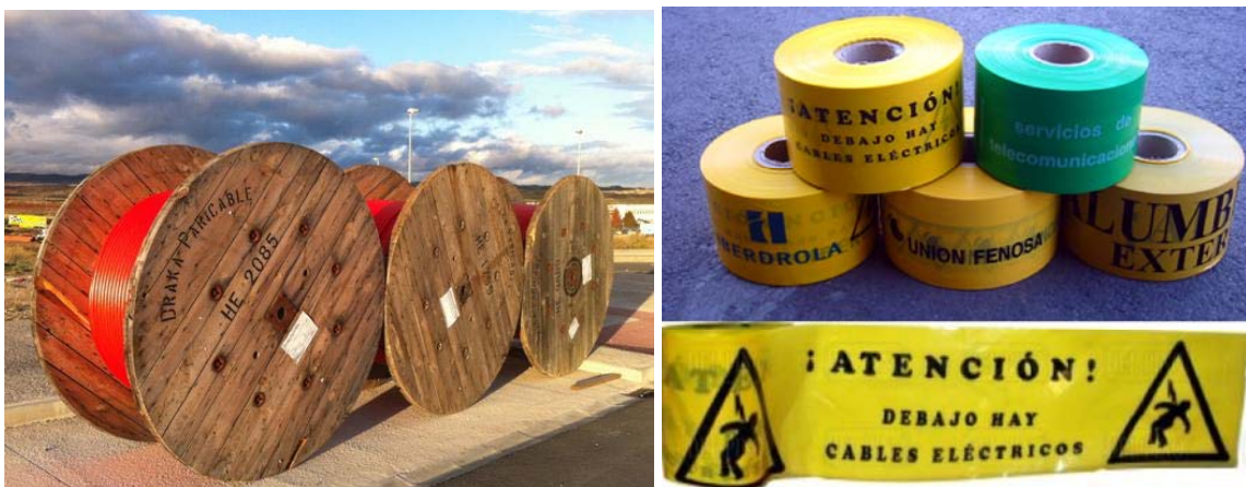
Fotos 13 y 14. Bobinas de cableado eléctrico, y cintas señalizadoras.
