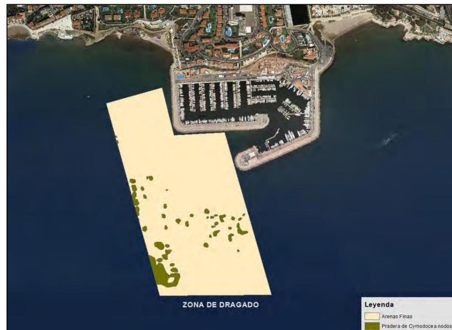
Figura 6.- Interpretación geomorfológica de la zona de dragado a partir de los datos de sónar de barrido lateral. (Fuente: Tecnoambiente)
