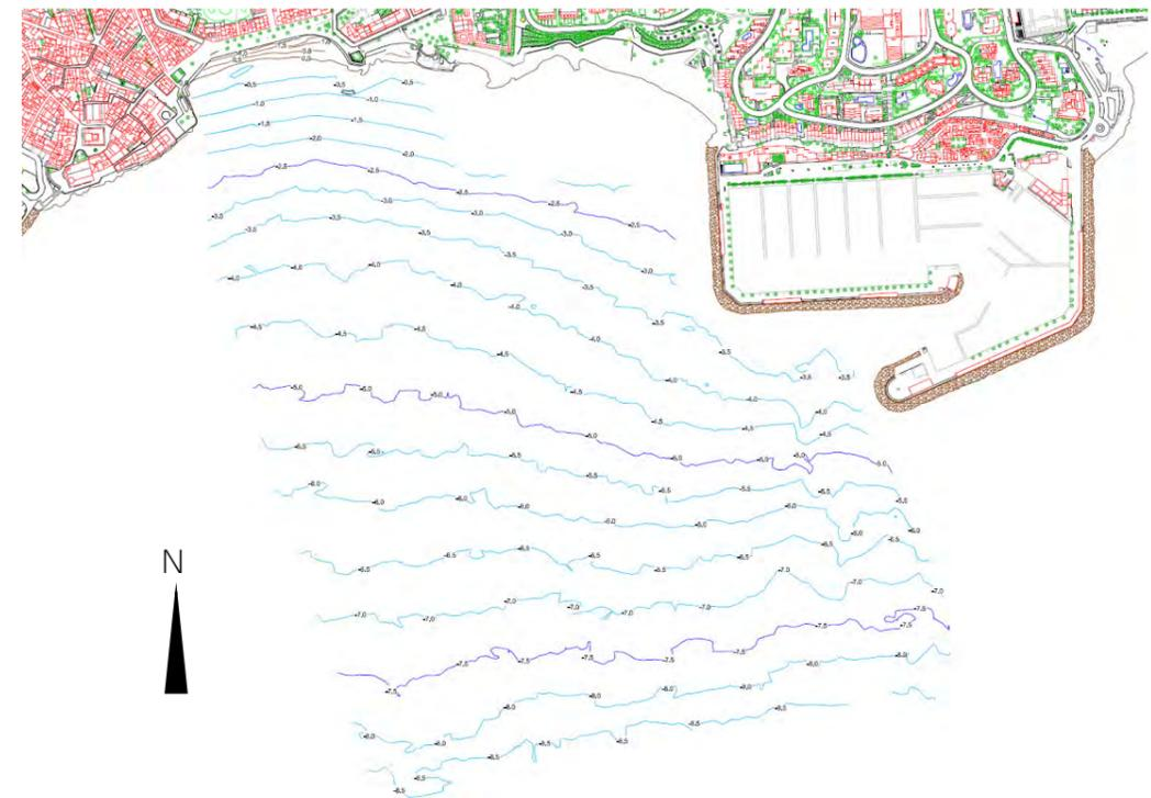
Figura 2.- Topografía y batimetría de la zona de actuación (Fuente: elaboración propio / Tecnoambiente)
