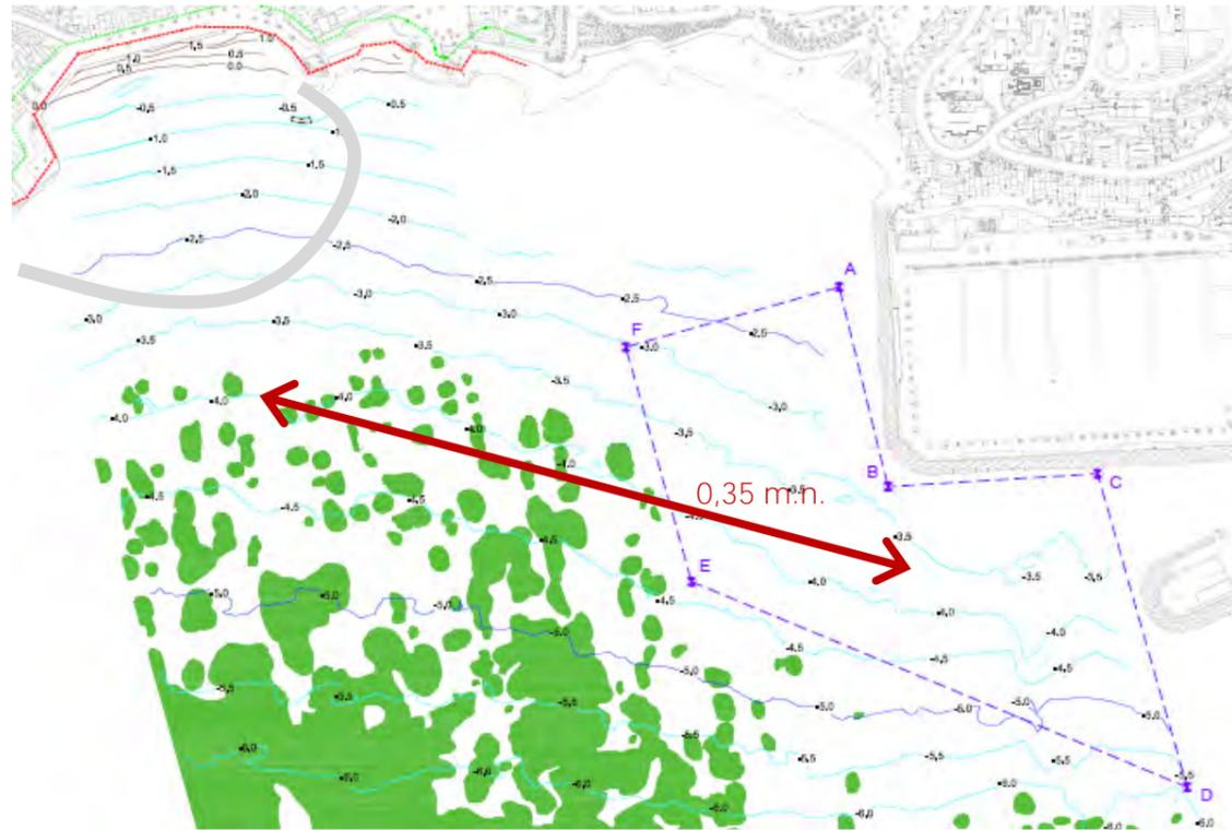
Figura 9.- Dimensiones de la zona donde puede efectuarse el dragado y distancia hasta la zona de vertido (Fuente: elaboración propia)
