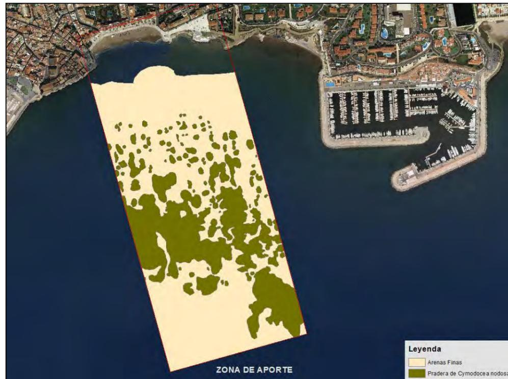
Figura 10.- Interpretación geomorfológica de la zona de aporte a partir de los datos de sónar de barrido lateral. (Fuente: Tecnoambiente)
