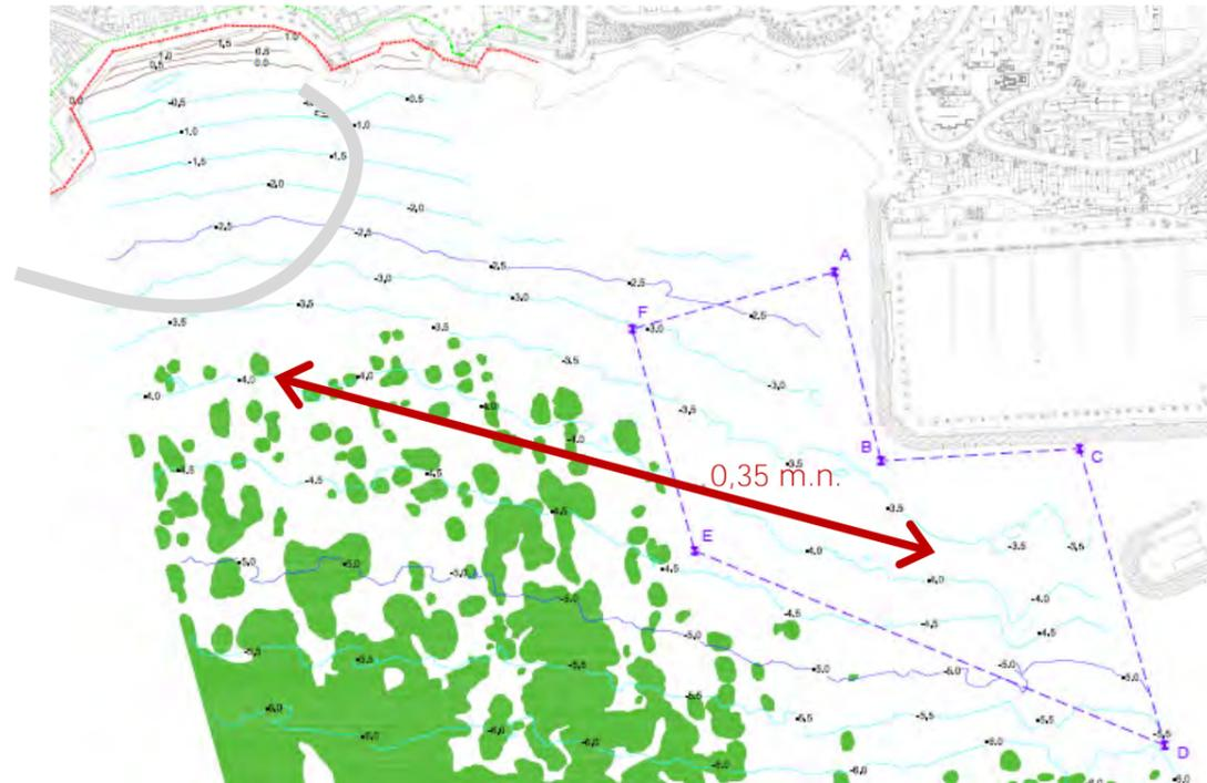
Figura 21.- Dimensiones de la zona donde puede efectuarse el dragado y distancia hasta la zona de vertido
