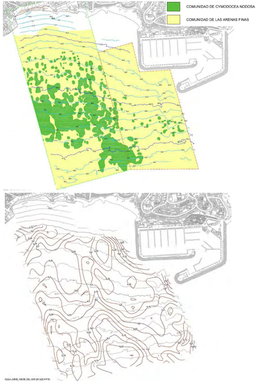
Figura 3.- Arriba: caracterización geomorfológica de los fondos; abajo: isopacas de sedimentos (Fuente: elaboración propia / Tecnoambiente)
