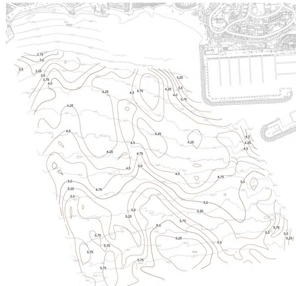
Figura 27.- Plano de isopacas de espesor de sedimento no consolidado sobre modelo 3D de la batimetría en la zona de estudio. (Fuente: Tecnoambiente)
