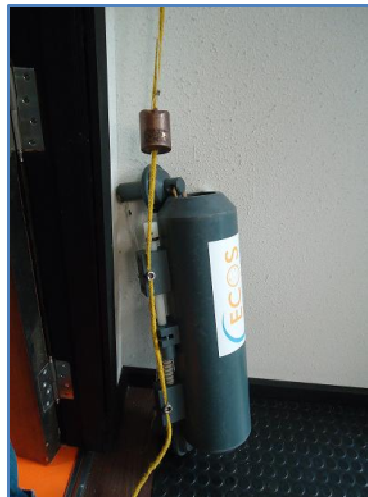
Ilustración 41 Botella basada en el diseño "Niskin" para la recogida de aguas.
