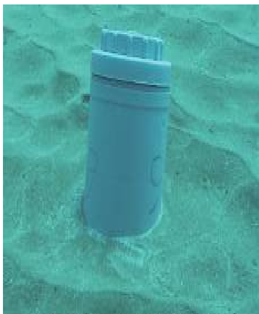
Ilustración 21 Tubo en PVC para la recogida de los sedimentos marinos.
