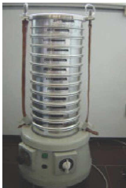
Ilustración 22 Tamizadora para el tamizaje en seco de las muestras de sedimentos.
