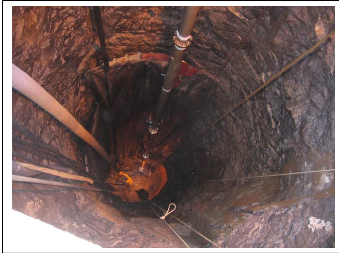
FOTOGRAFÍA N°2.- MUESTRA UNA VISTA DEL POZO QUE TIENE UNA PROFUNDIDAD DE 27 METROS. A LOS 22 M DE PROFUNDIDAD SE HA CONSTRUIDO UNA GALERÍA DE 86 METROS.
