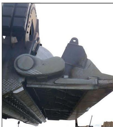
Figura 7. Cabezal de succión de una draga TSHD
