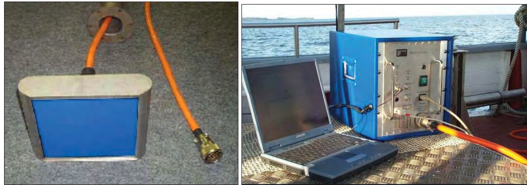
Figura 7. Perfilador INNOMAR SES-2000 COMPACT; Transducer y centralita electrónica, respectivamente
