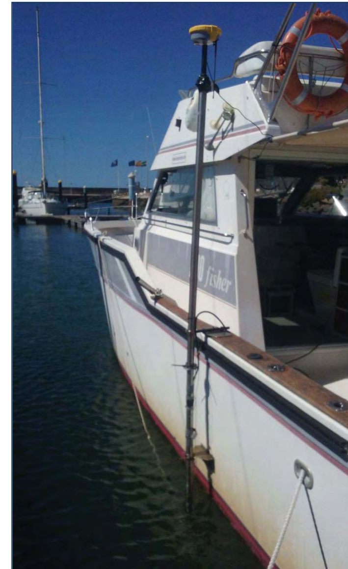
Figura 6. Fotografía de la instalación del transductor en la borda del barco. El GPS se encuentra sobre el mismo eje que el transductor.
