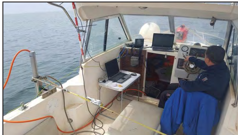
Figura 8. Instalación del Transducer en la borda de la embarcación
