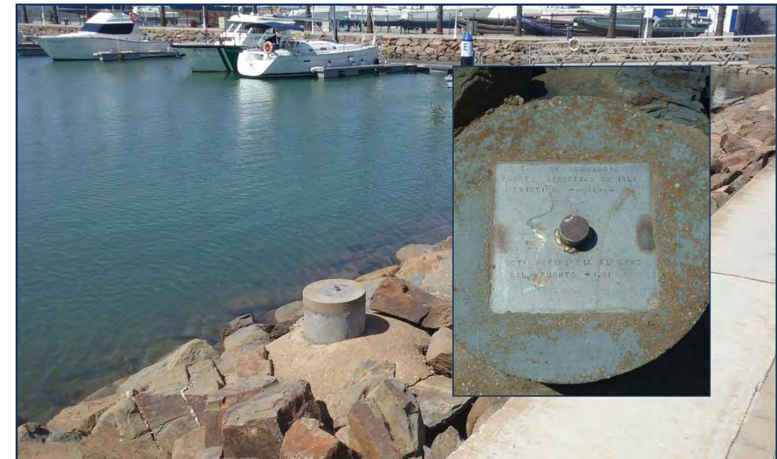
Figura 2. Hito de referencia del cero hidrográfico para los trabajos de topografía e hidrografía.
