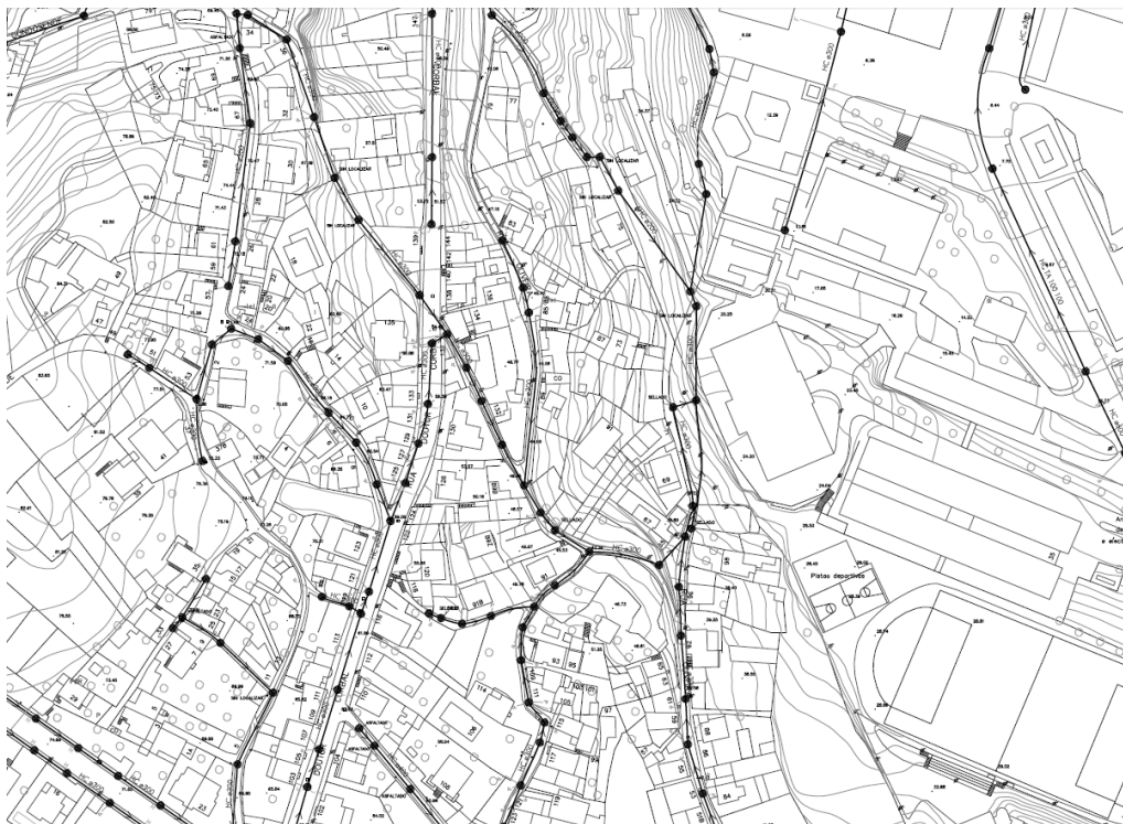
Zona Sur en la que se aprecia el colector de bajada hacia la ETEA recogiendo la zona sur de la Rúa Doctor Corbal y la zona de la Travesía de Oliveira. en la que se puede apreciar el punto de conexión con las instalaciones de la ETEA y el ámbito de actuación del colector de la Rúa Doctor Corbal que llega hasta el Camino de Gondosende
