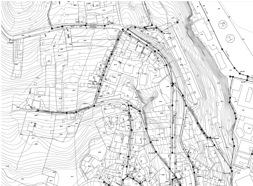
Zona Norte en la que se puede apreciar el punto de conexión con las instalaciones de la ETEA y el ámbito de actuación del colector de la Rúa Doctor Corbal que llega hasta el Camino de Gondosende
