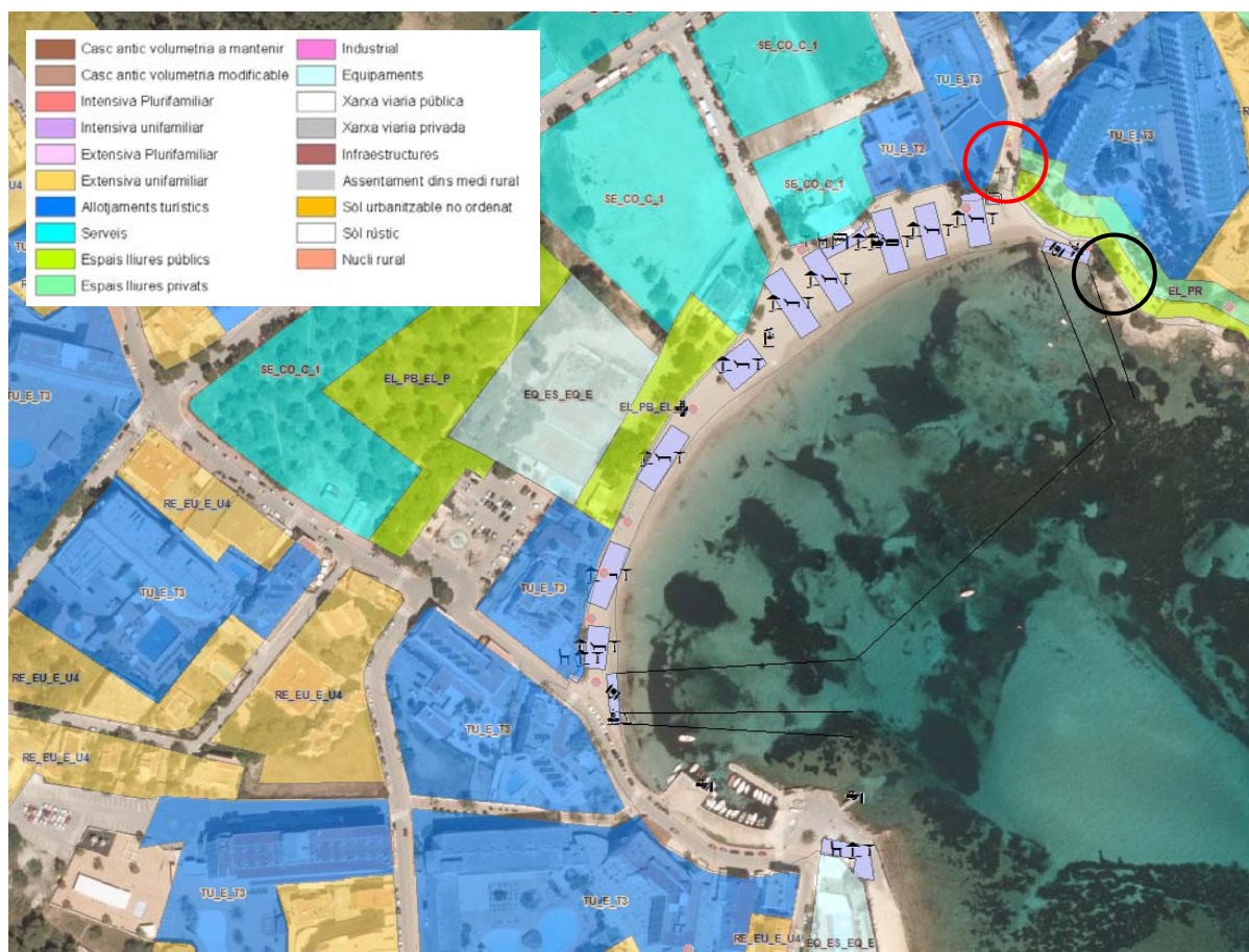
Figura 2. Remarcado en rojo, actual punto de vertido del torrente des Canar y en negro el nuevo punto proyectado, sobre calificación del suelo urbano según el Mapa Urbanístico de las Islas Baleares, incluidas las instalaciones de servicio de temporada en el DPMT. Fuente: bases cartográficas del IDEIB.
