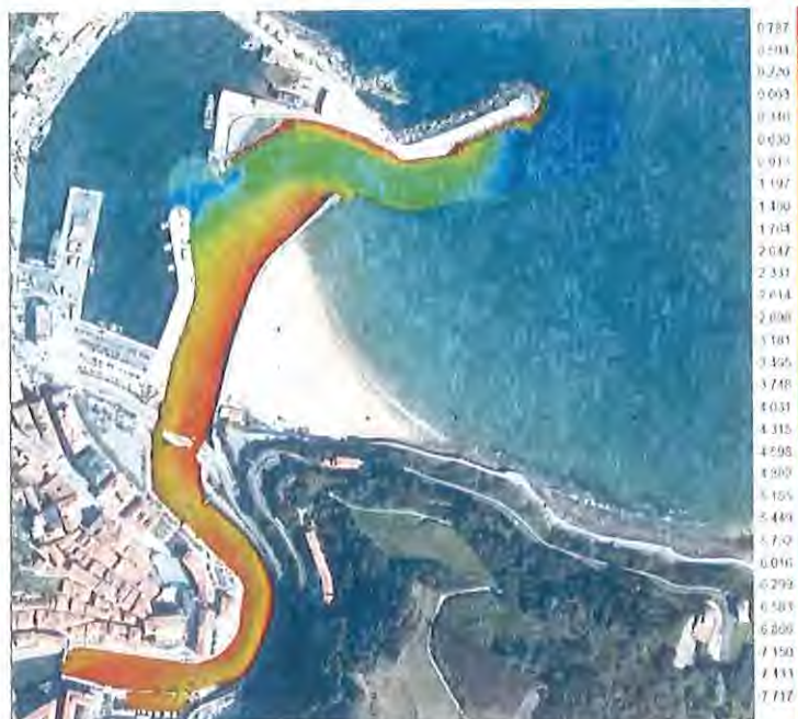
Figura 3. Batimetría realizada en junio de 2020 (la escala de color refiere a la profundidad en metros).
