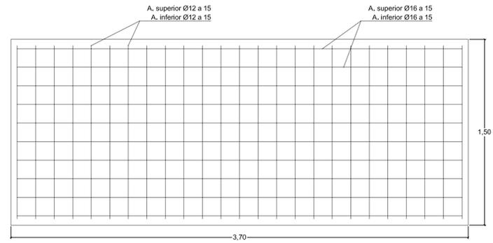
Planta estructura canal, Losa de cubierta.
