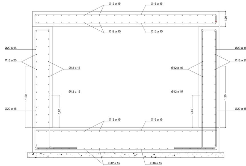
Sección estructura canal, tramo cubierto
