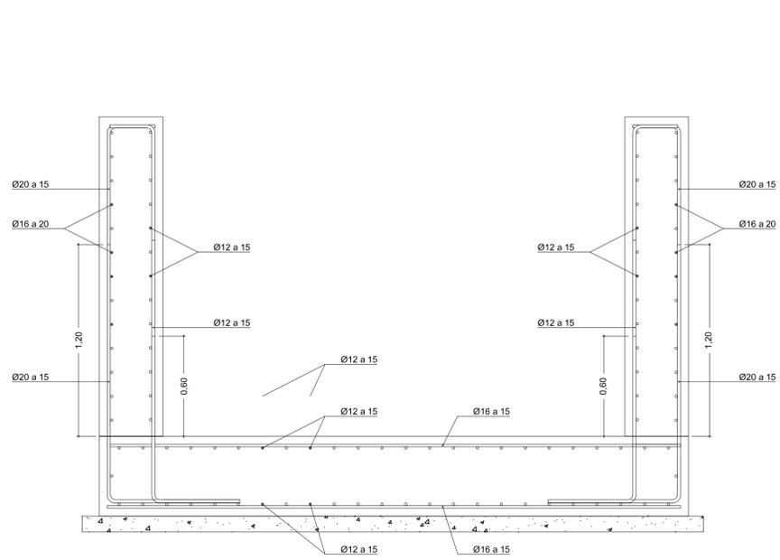
Sección estructura canal, tramo descubierto
