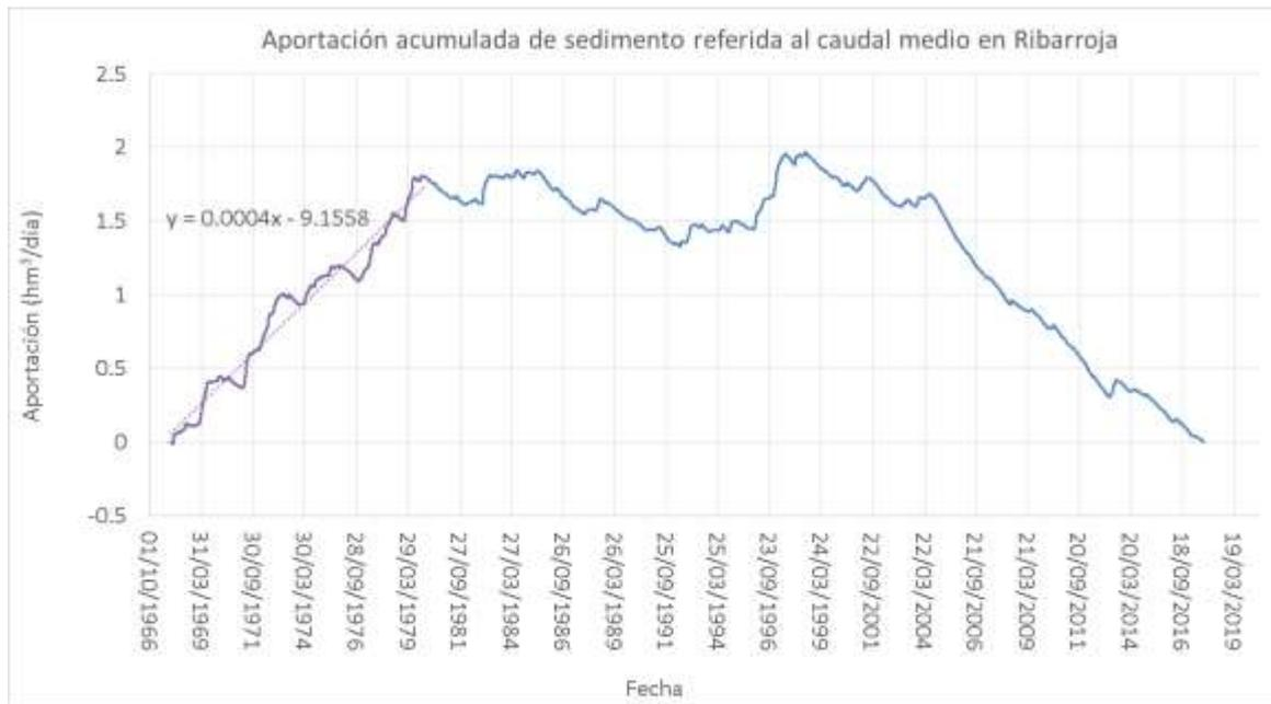
Figura 32. Rango medio de sedimentación acumulada referida al caudal medio en el embalse de Ribarroja. Ajuste del caudal del tramo 1967-1980
