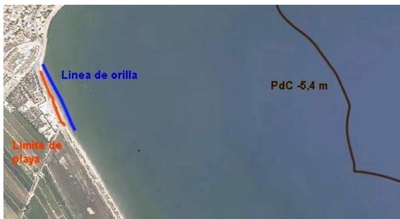
Figura 5.35: Esquema de la zona en la playa de El Arenal y variables utilizadas para determinar el retroceso de la costa (Foto: IGN)
