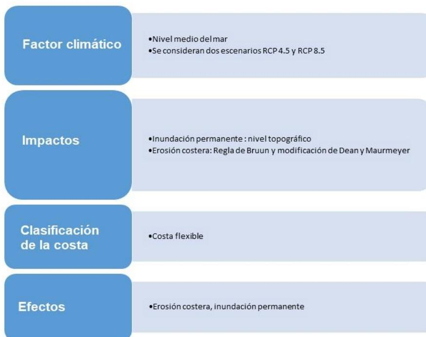
Figura 5.29: Esquema metodológico seguido para el análisis del efecto del Cambio Climático en la costa del Delta del Ebro
