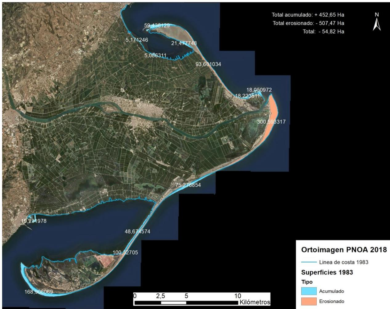
Figura 4.60: Variación de superficie de la costa del Delta del Ebro entre 1983 y 2018 (Ortoimagen: IGN)
