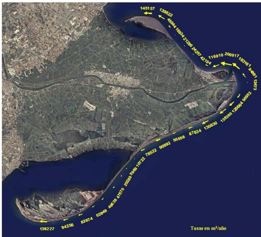
Figura 2.42: Cálculo teórico del transporte longitudinal de sedimentos a lo largo del Delta usando la fórmula del CERC (Fuente: IHAC, 2011)
