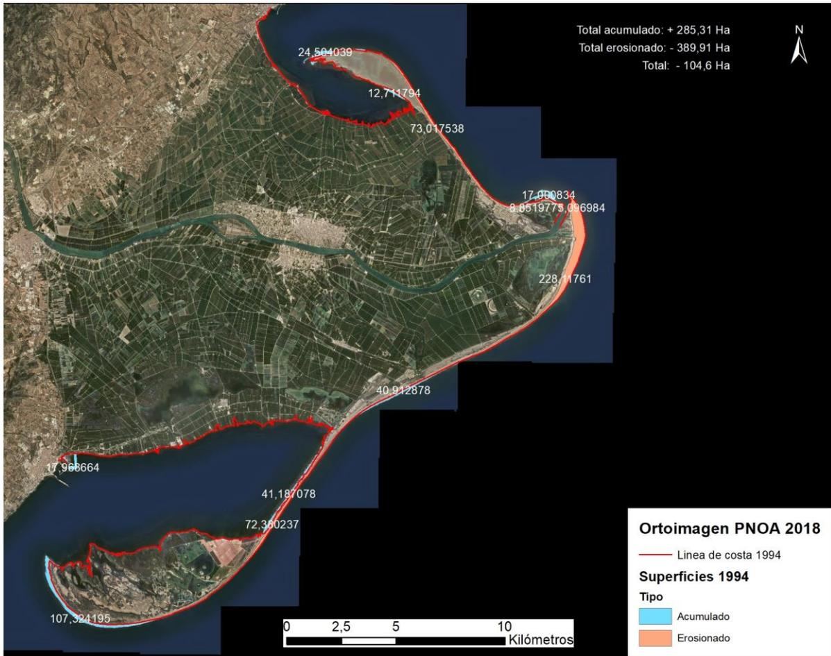
Figura 4.61: Variación de superficie de la costa del Delta del Ebro entre 1994 y 2018 (Ortoimagen: IGN)
