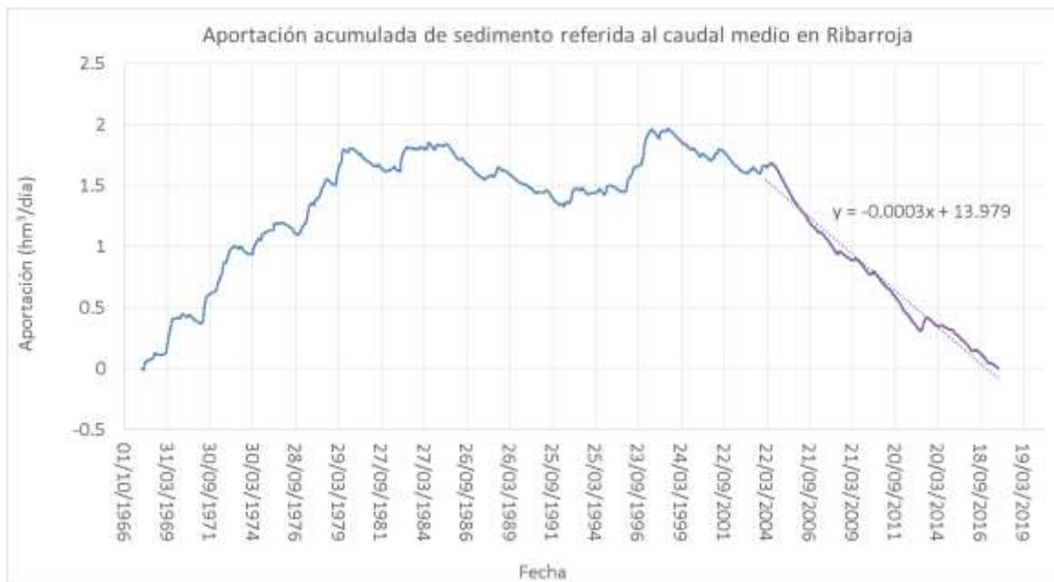
Figura 33. Rango medio de sedimentación acumulada referida al caudal medio en el embalse de Ribarroja. Ajuste del caudal del tramo 2004-2016
