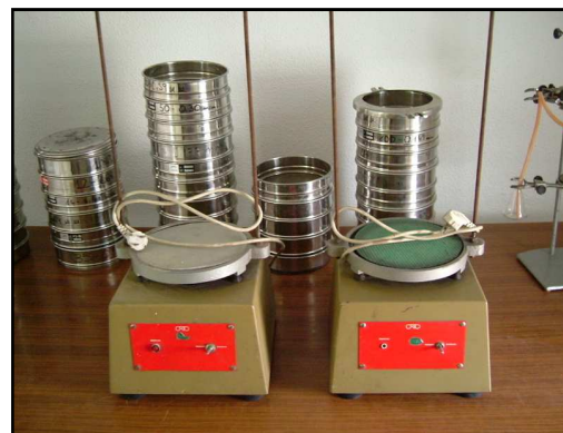
Figura 21 Tamizadoras y tamices.
