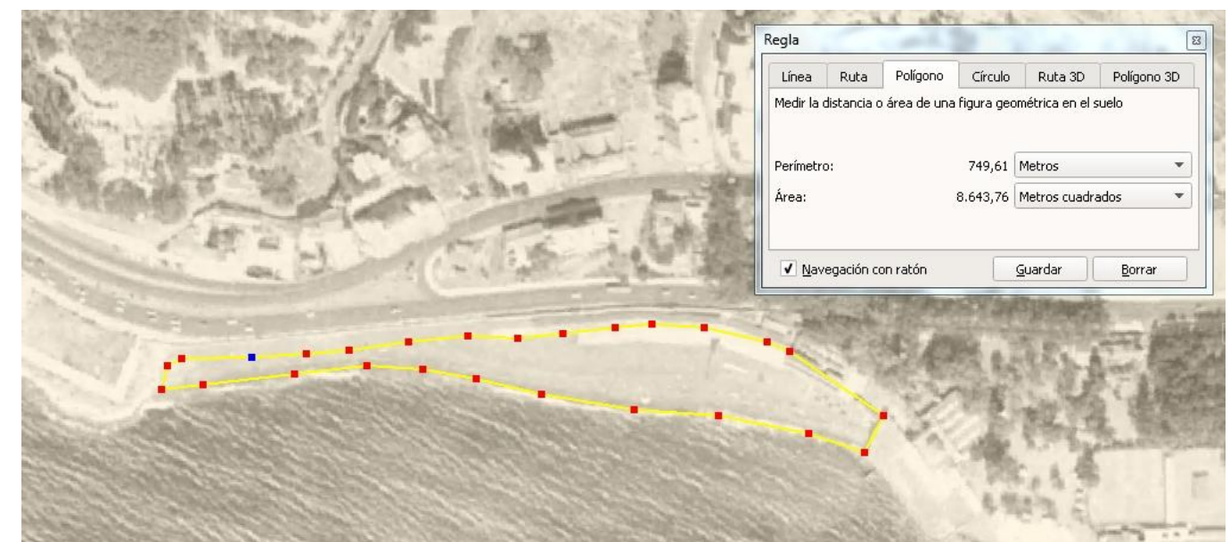
Figura 13.- Año 1984. Superficie de playa de unos 8.700 m 2 , tras justo la construcción de obras de rigidización de playa en Pedregalejo – El Palo.
