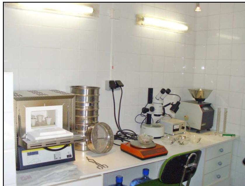
Figura 22 Equipos utilizados para la determinación del contenido de materia orgánica
