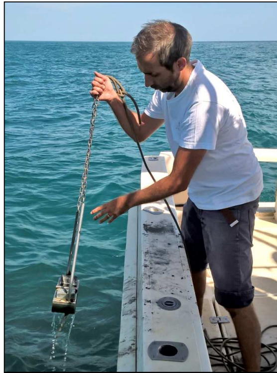
Figura 13 Operación de toma de muestra con draga Van-Veen
