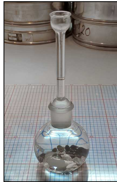
Figura 23 Picnómetro utilizado durante la determinación de la densidad de grano
