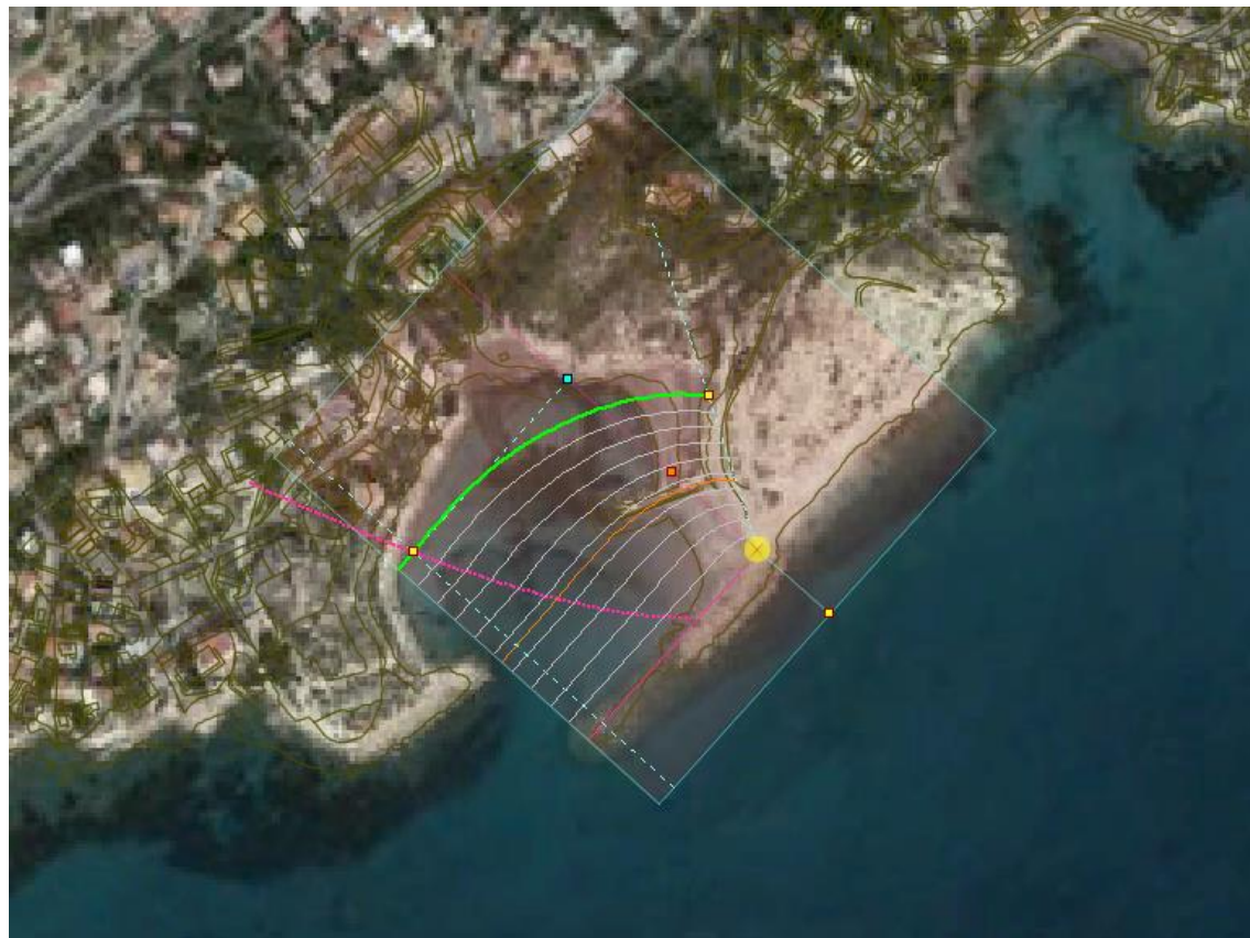
Imagen 50 : Forma en planta de equilibrio de la alternativa seleccionada y definida en SMC con el flujo de media considerado. Fuente: Elaboración propia.
