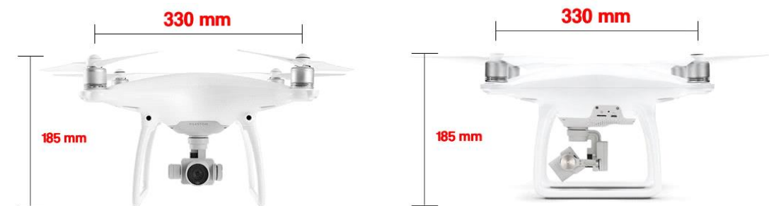
Imagen 9: DJI Phantom 4 pro. Fuente: Elaboración propia.
