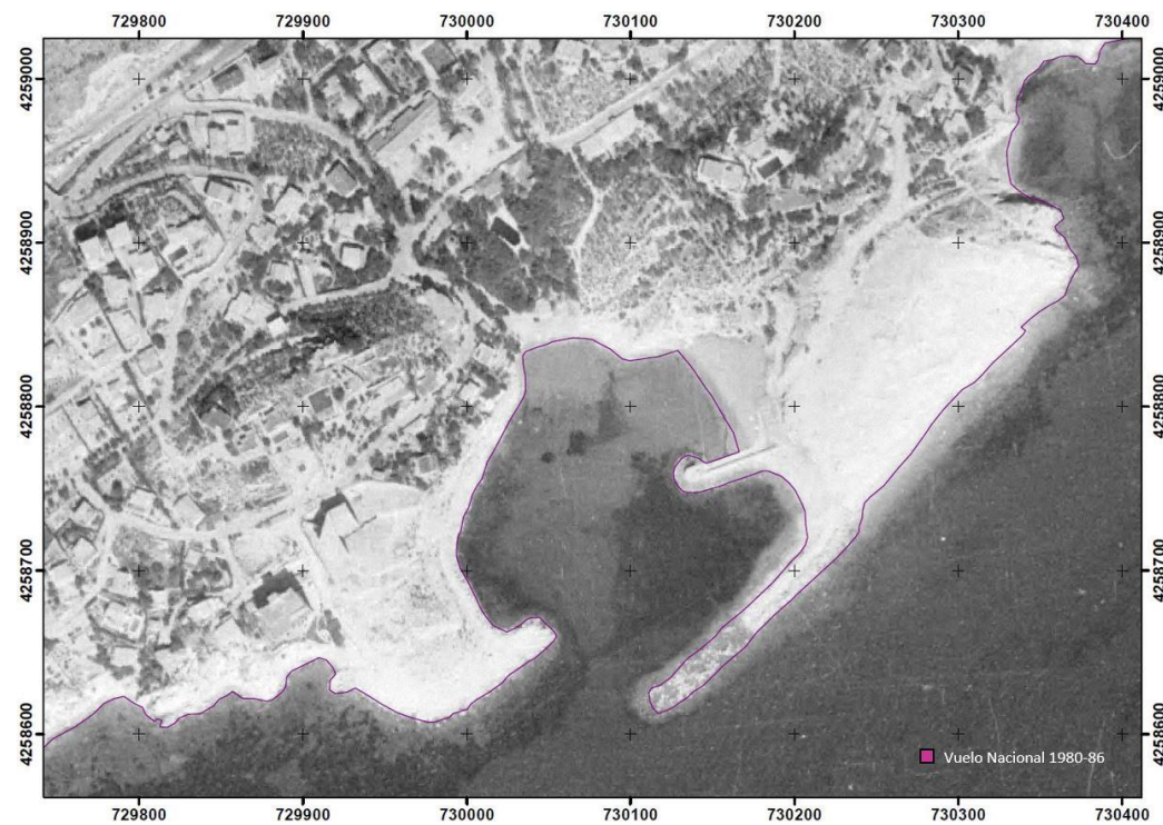
Imagen 21: Línea de costa obtenida a partir de restitución del vuelo vertical Nacional 1980-86. Fuente: Elaboración propia con datos del IGN.
