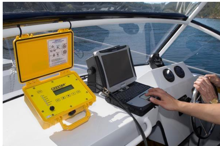
Imagen 4: Unidad de control de la Cee Hydrosystems Ceestar. Fuente: Elaboración propia.
