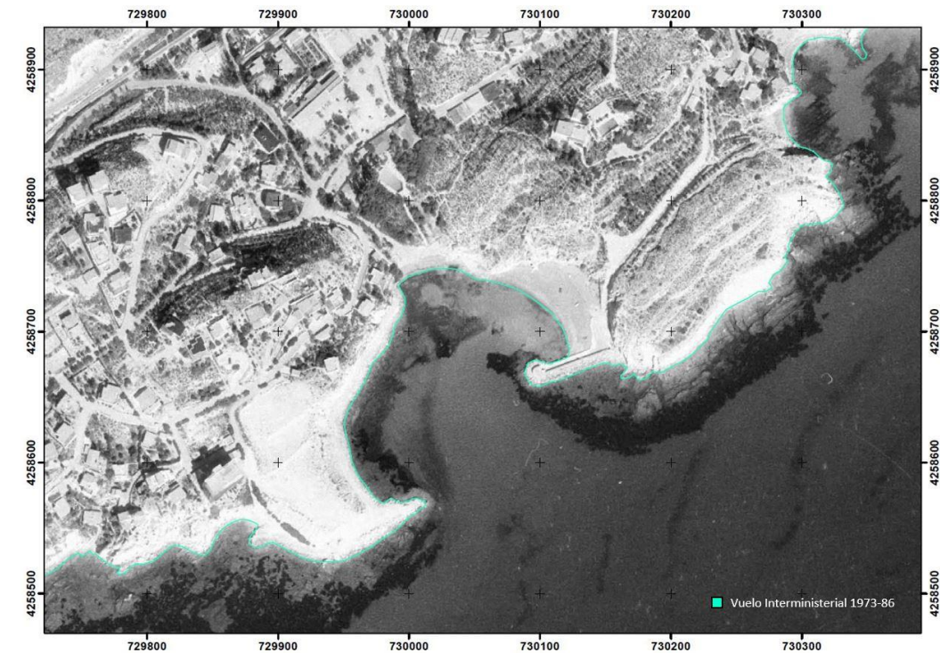
Imagen 20: Línea de costa obtenida a partir de restitución del vuelo vertical Interministerial 1973-86. Fuente: Elaboración propia con datos del IGN.
