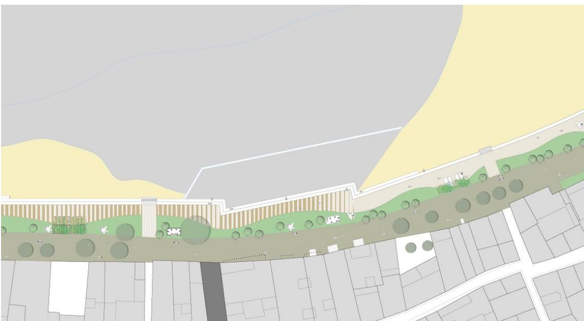
Alternativa evaluada con muro de retención del agua de marea, para generar piscinas naturales entre los dos arenales.
