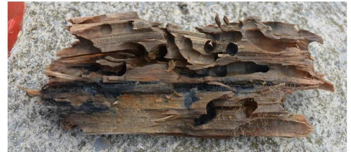
Figura 5. Fragmento del pilote extraído con los taladros tubulares a la vista
