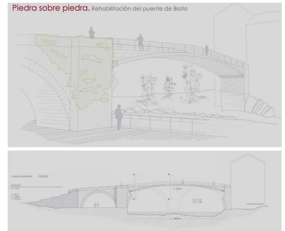
Figura 21. Propuesta de FHECOR para la continuidad del puente de Broto, que perdió una pila y las dos bóvedas concurrentes durante la Guerra Civil
