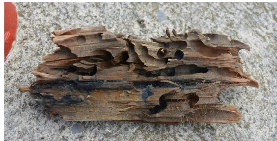
Figura 6. Fragmento del pilote extraído con los taladros tubulares a la vista
