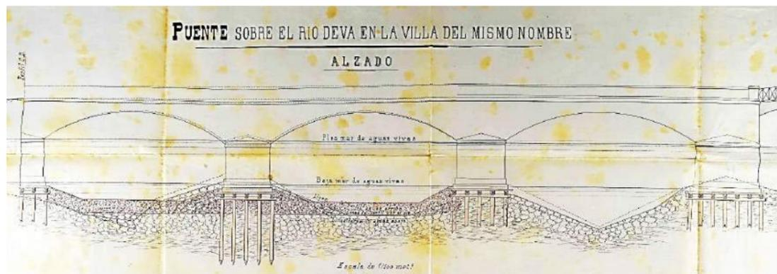
Figura 7. Alzado de aguas abajo de las tres primeras bóvedas, tomada de los planos del proyecto de reparación de 1892-1893 (ver referencia [1]). Se observa el descenso de la pila 1 y las medidas propuestas en el lecho del cauce bajo las bóvedas 1 y 2.
