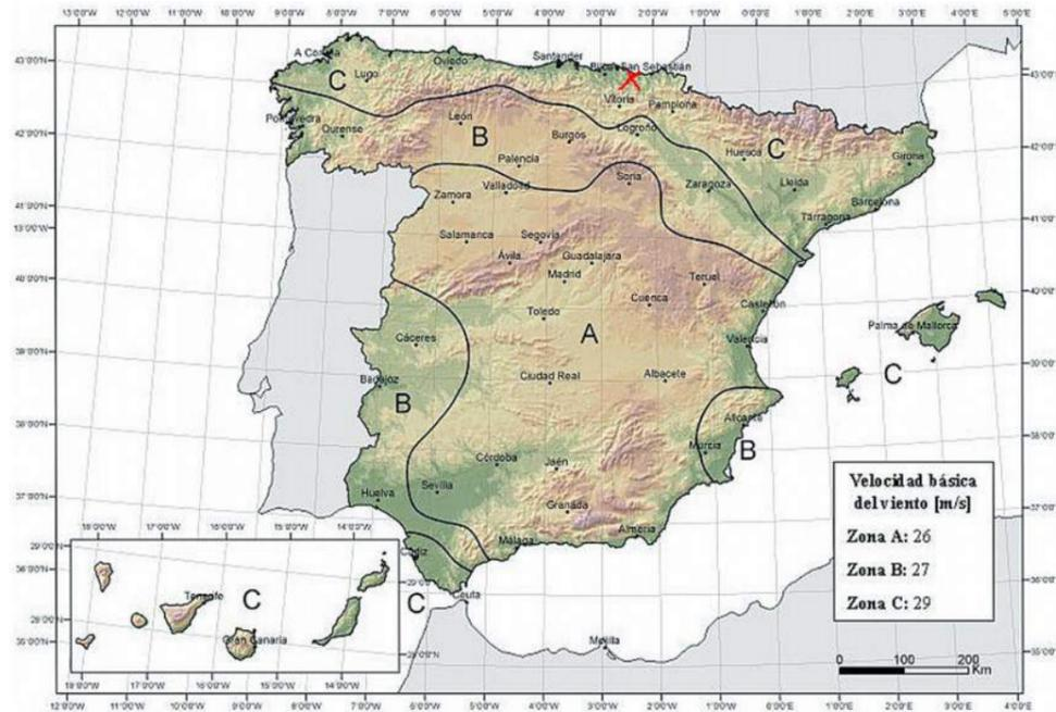
Figura 17. IAP-11. Mapa de isotacas para la obtención de la velocidad básica fundamental del viento
