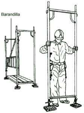
7 Colocación de las barandillas y posicionamiento del siguiente suplemento
