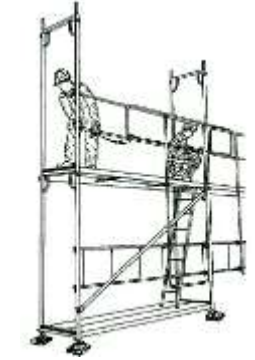
15 Montaje del resto del andamio
