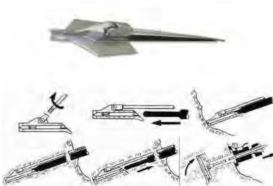
Figura 8.13. Anclaje Manta Ray e instalación del mismo.
