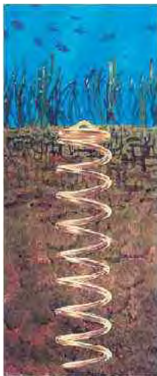
Figura 8.10. Tipología de anclajes Harmony tipo P.
