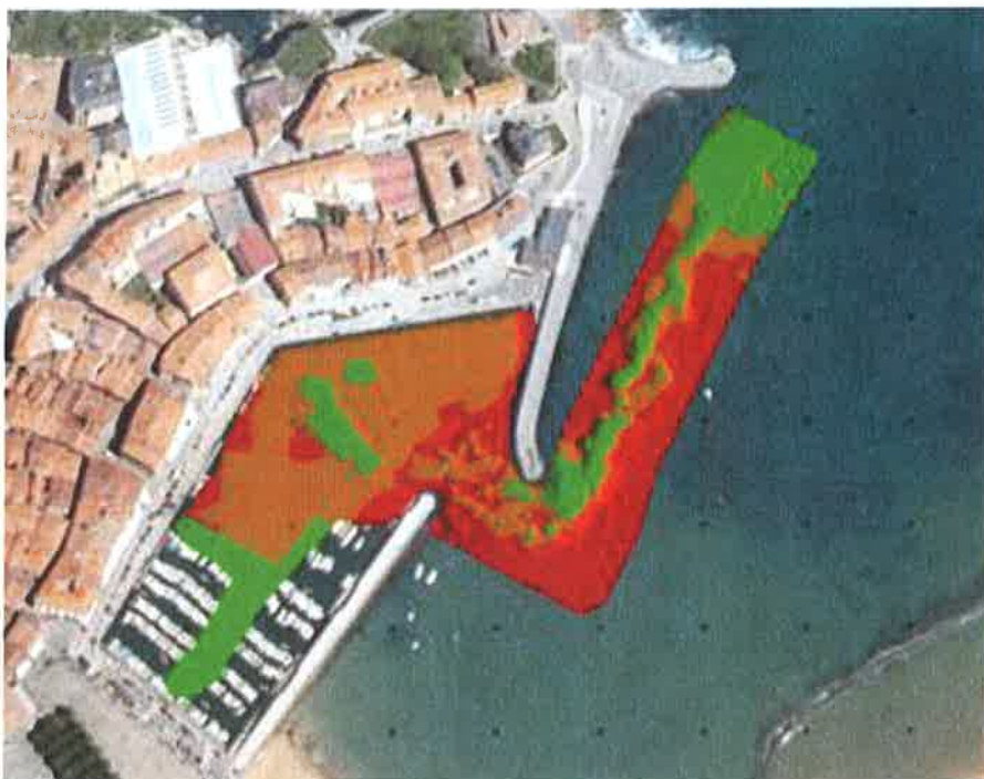
Figuras 2 y 3. Calados en el Puerto de Lekeitio antes (abril: se señala, con polígono blanco, la principal zona de acumulación de sedimento) y después (junio) de la realización del último dragado (2015). Rojo: no se alcanza el calado mínimo (-3 m); naranja: no se llega al calado nominal (-4 m); verde: se supera dicho calado nominal.
