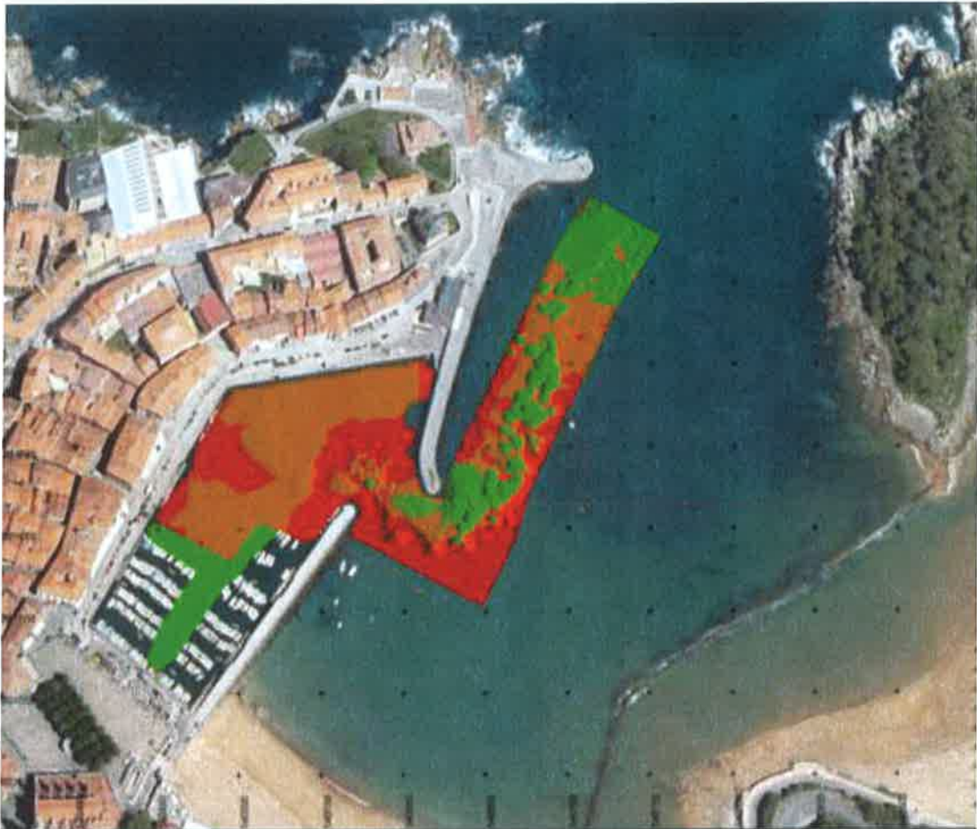
Figura 22. Situación de calados en el interior de la dársena y canal de acceso al puerto de Lekeitio en la batimetría del 1 de junio de 2017 (tras el trasvase)
