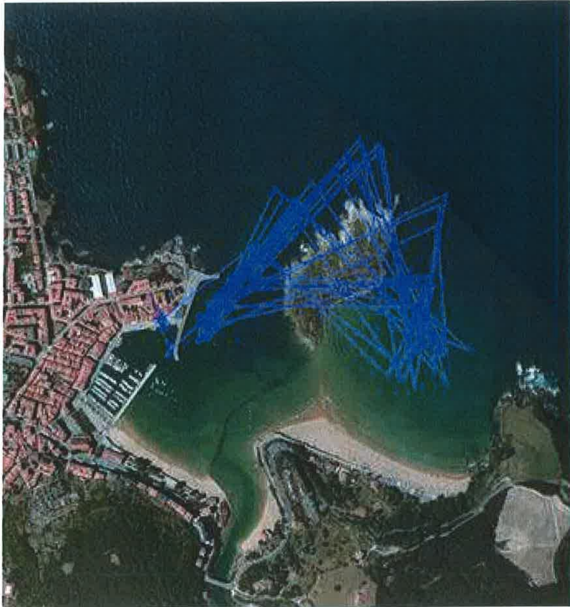
Movimientos del gánguil “DRAGARENA” el viernes 27 de Mayo del 2016 entre el puerto de Lekeitio y la playa del Karraspio. Vertidos registrados (13): 8:23, 9:38, 10:23, 11:13, 12:03, 12:48, 13:53, 14:58, 15:43, 16:33, 17:18, 17:58 y 18:43.
