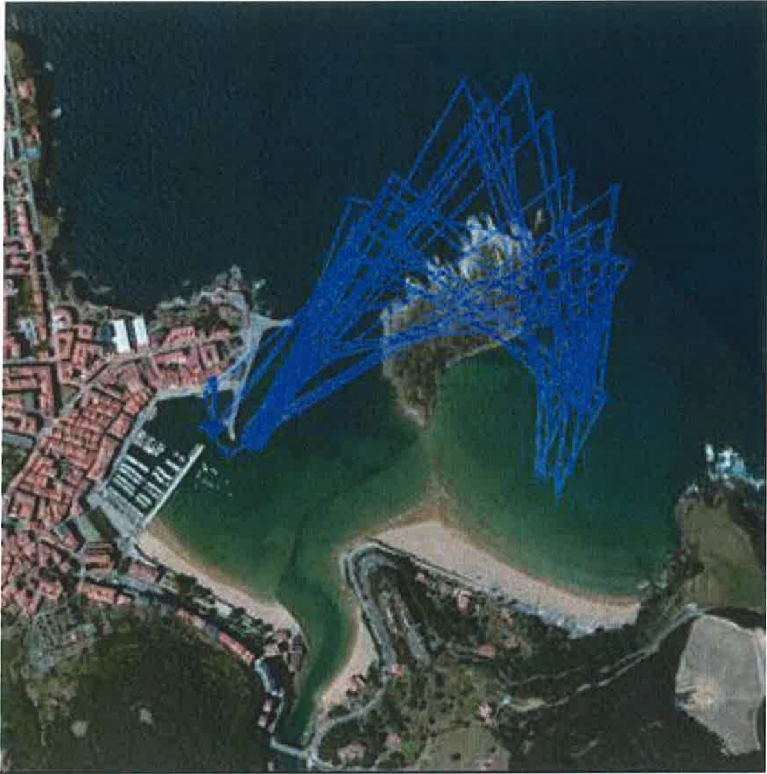
Movimientos del gánguil "DRAGARENA" el lunes 23 de Mayo del 2016 entre el puerto de Lekeitio y la playa del Karraspio. Vertidos registrados (13): 7:59, 8:49, 9:34, 10:29, 11:14, 12:09, 12:54, 13:34, 14:23, 15:18, 16:18, 17:13 y 18:23.
