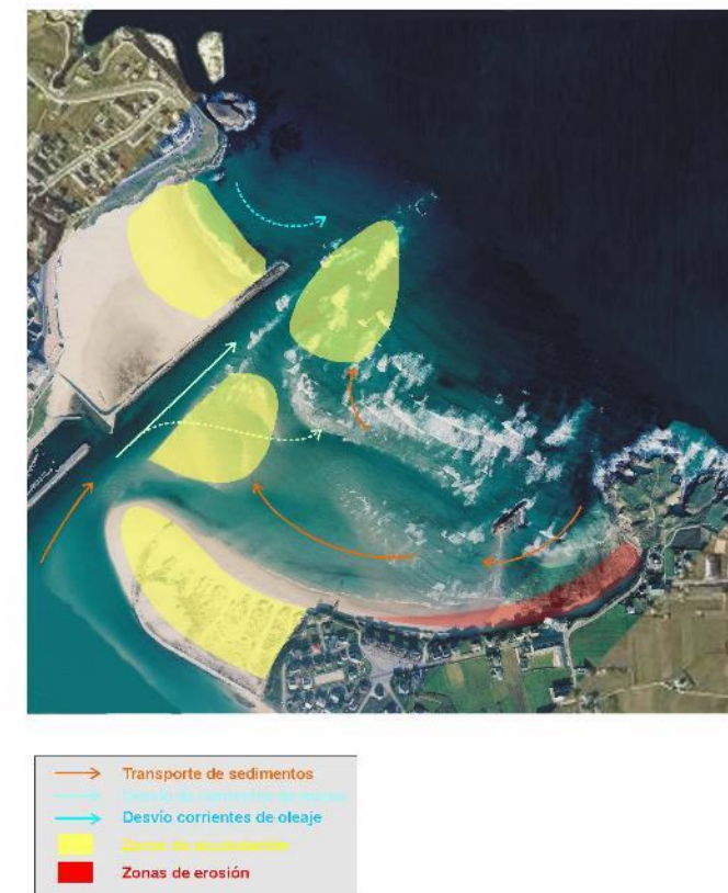
Figura 3.4 “Esquema general del impacto causado por el encauzamiento del canal sobre la ensenada
