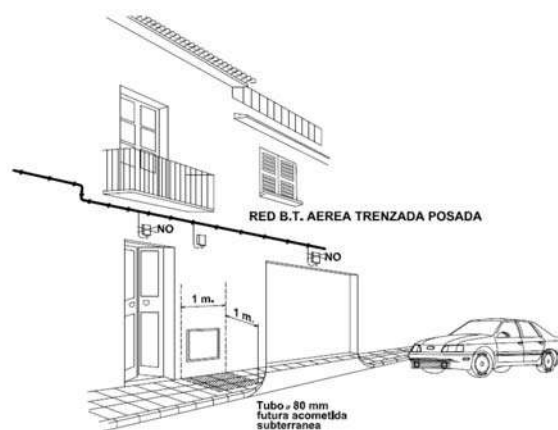
Figura 2. Emplazamiento de la Caja General de Protección
