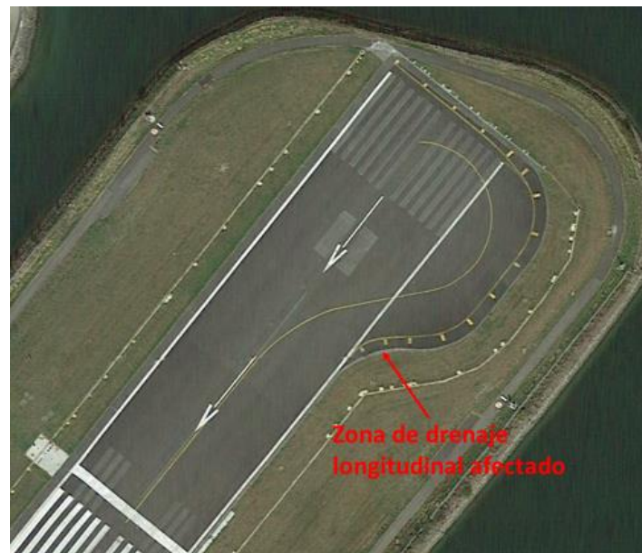
Imagen 27 Drenaje afectado en cabecera 22. Fuente: Elaboración propia.
