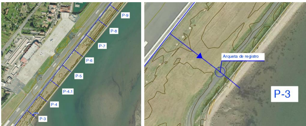
Imagen 14. Colectores de drenaje en franja. Fuente: Elaboración propia.
