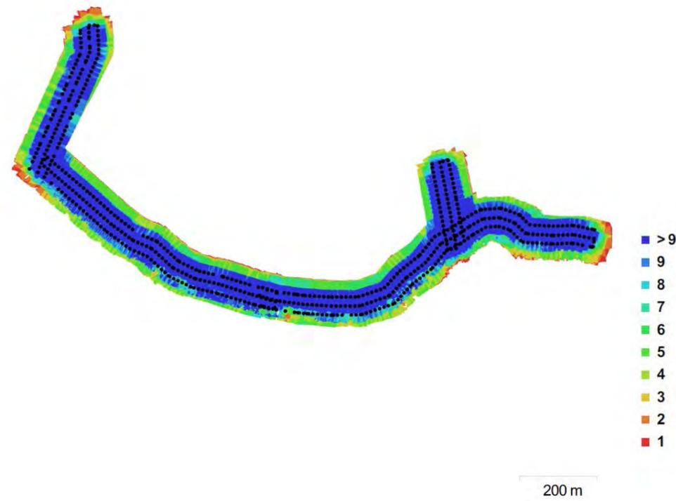
Imagen 10: Posiciones de la cámara y solapamiento de imágenes. Fuente: GeoBIM.
