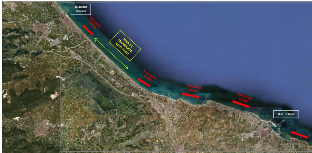
Imagen 3: Patrón direccional de la dinámica litoral en la costa dianense. Fuente: Proyecto de recuperación del tramo de costa entre los puertos de Oliva y Denia.
