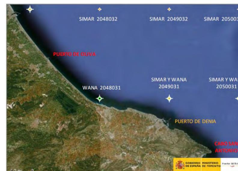
Imagen 8: Localización de las distintas fuentes del Banco de Datos Oceanográficos de Puertos del Estado. Fuente: Proyecto de recuperación del tramo de costa entre los puertos de Oliva y Denia.
