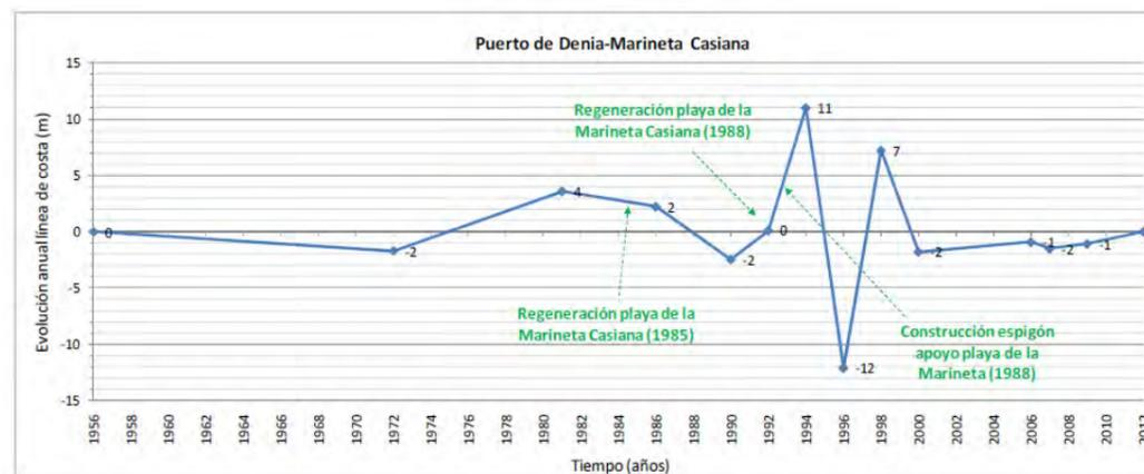
Imagen 3: Representación del balance anual de erosión/acreción en la serie temporal analizada Fuente: Proyecto de recuperación del tramo de costa entre los puertos de Oliva y Denia.
