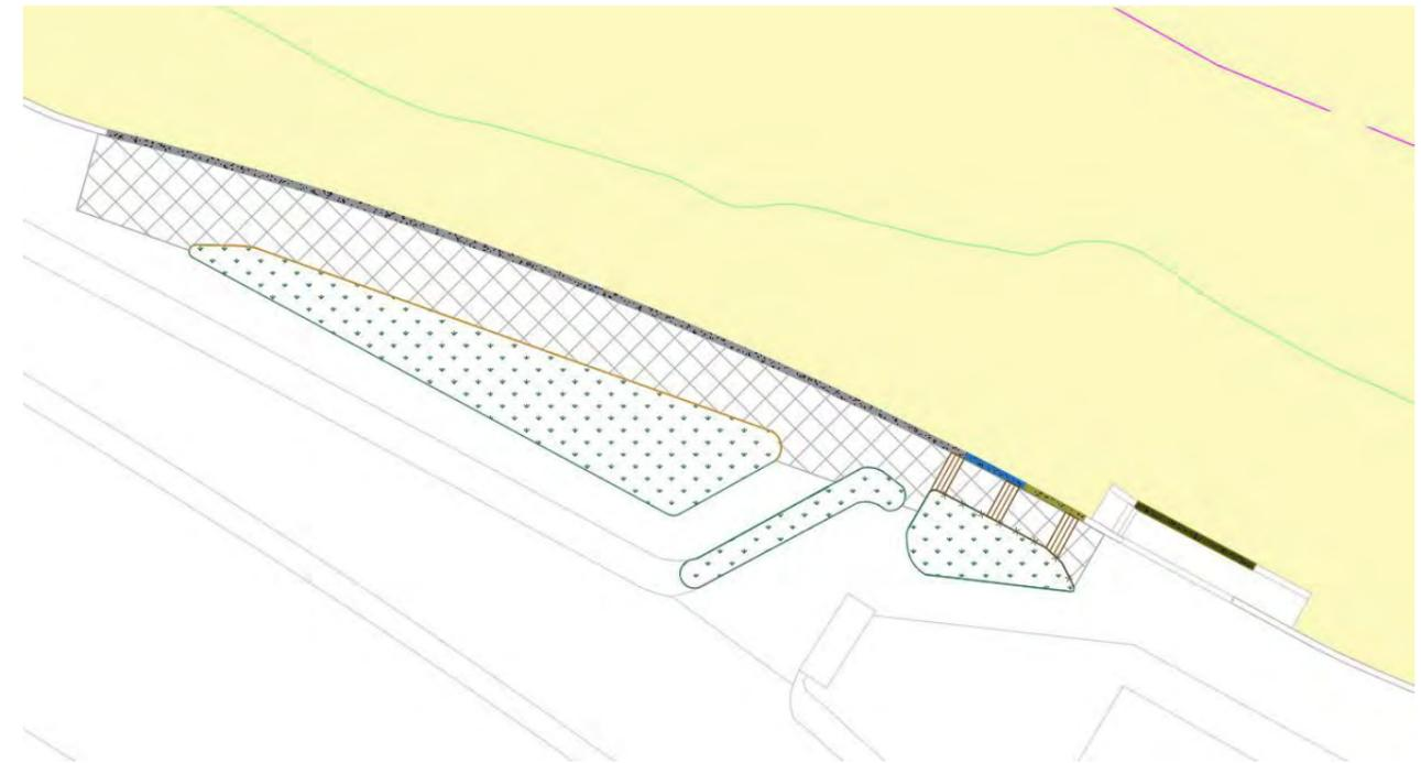
Imagen 4: Disposición del paseo marítimo tras la retirada del mirador y del saliente curvo. Fuente: Elaboración propia.
