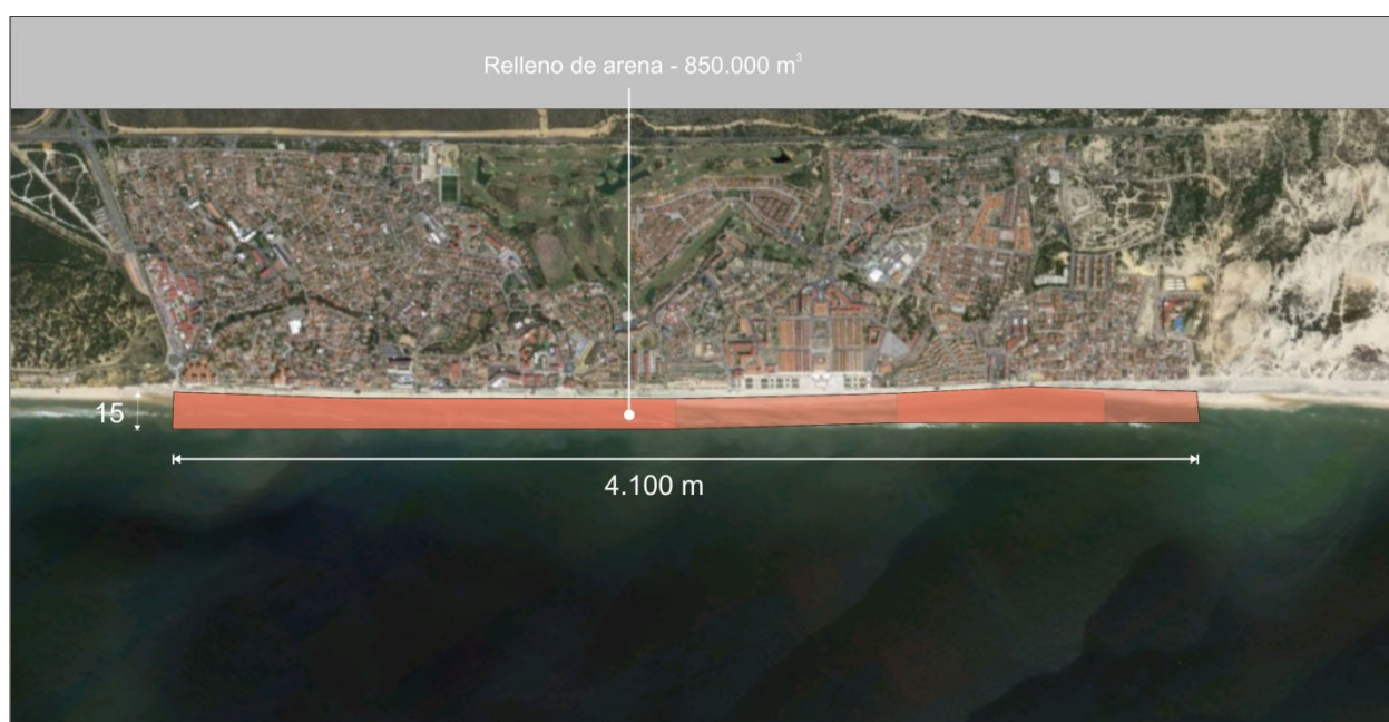
Figura 4.1 – Esquema de la Alternativa 1 - Relleno de 850.000 m 3 de arena
