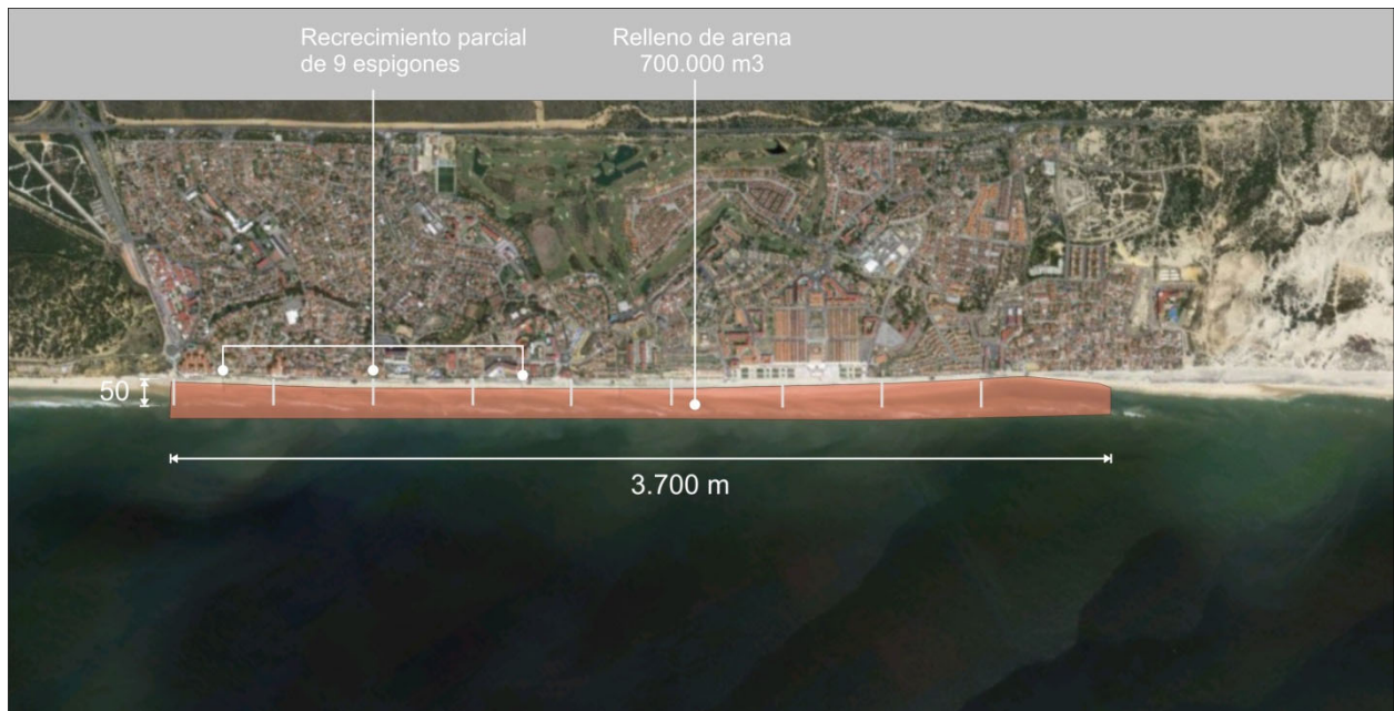
Figura 3.1 – Esquema de las obras de regeneración
