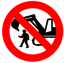
Prohibido permanecer en el radio de acción de la maquinaria
